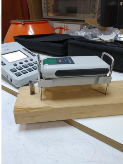
Şekil 3.11. Marsurf M300 iğne taramalı portatif yüzey ölçüm cihazı ve numune
