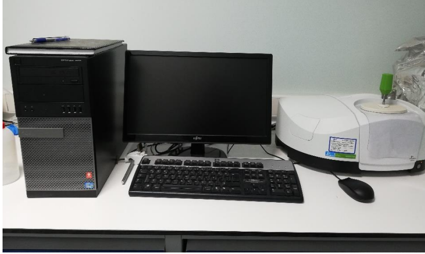
Resim 3.4 Çalışmada kullanılan ATR-FTIR cihazı
