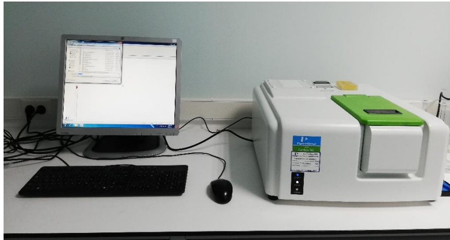
Resim 3.6 Çalışmada kullanılan UV spektrofotometre cihazı
