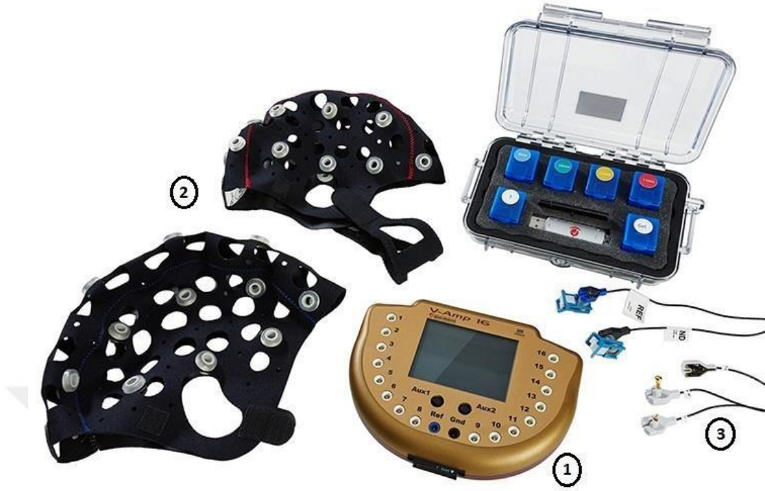
Şekil 12. 16 Kanallı bir EEG set örneği: 1. Elektriksel sinyal güçlendirici, 2. Kep, 3. Elektrotlar
