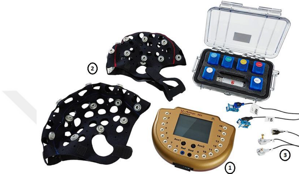
Şekil 1: 1. Elektriksel sinyal güçlendirici, 2. Başlık, 3. Elektrotlar numaralandırılmış olarak gösterilmektedir.
