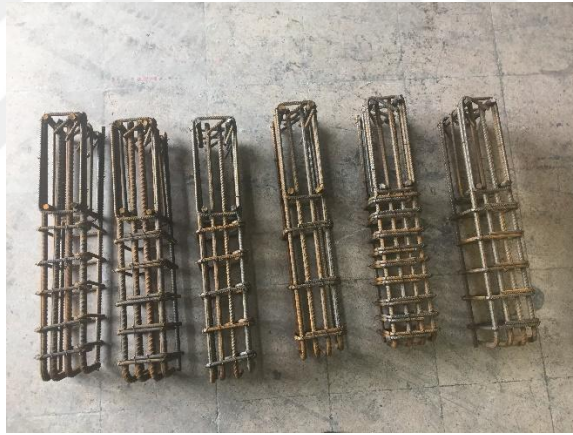
Şekil 3.11. Oluşturulmuş bazı numune donatılarının gerçek görüntüsü
