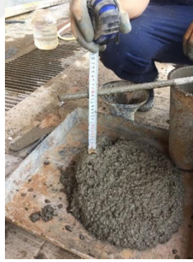
Şekil 3.15. Çökme deneyi görüntüsü
