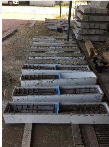
Şekil 3.18. Bazı numunelerin beton dökümünden önceki halleri
