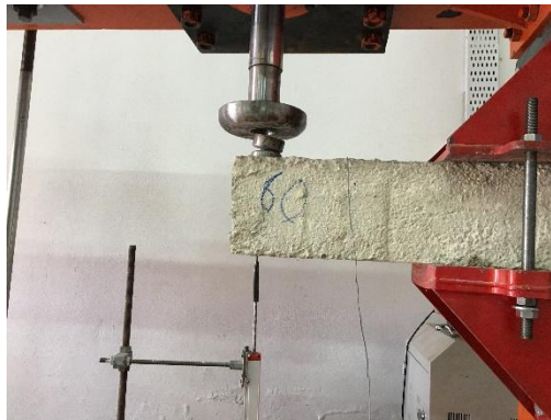
Şekil 4.4. %10 demir talaşı katkılı olan deney numunesinin deney öncesi görüntüsü
