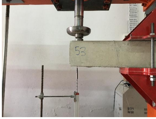
Şekil 4.2. %20 demir talaşı katkılı olan deney numunesinin deney öncesi görüntüsü
