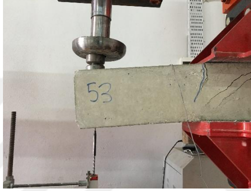
Şekil 4.3. %20 demir talaşı katkılı olan deney numunesinin deney sonrası görüntüsü
