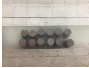
Şekil 3.16. Silindir numunelerin kür havuzundaki görüntüsü
