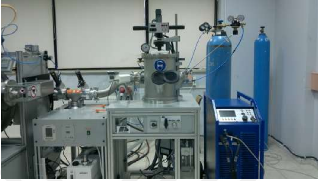
Şekil 5.1. Ark yöntemi ile eritme sistemi (Arc- Melter).
