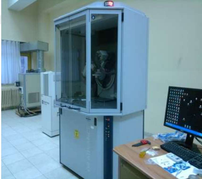
Şekil 5.3. X-ışını kırınım (XRD) analizi yapılan sistem
