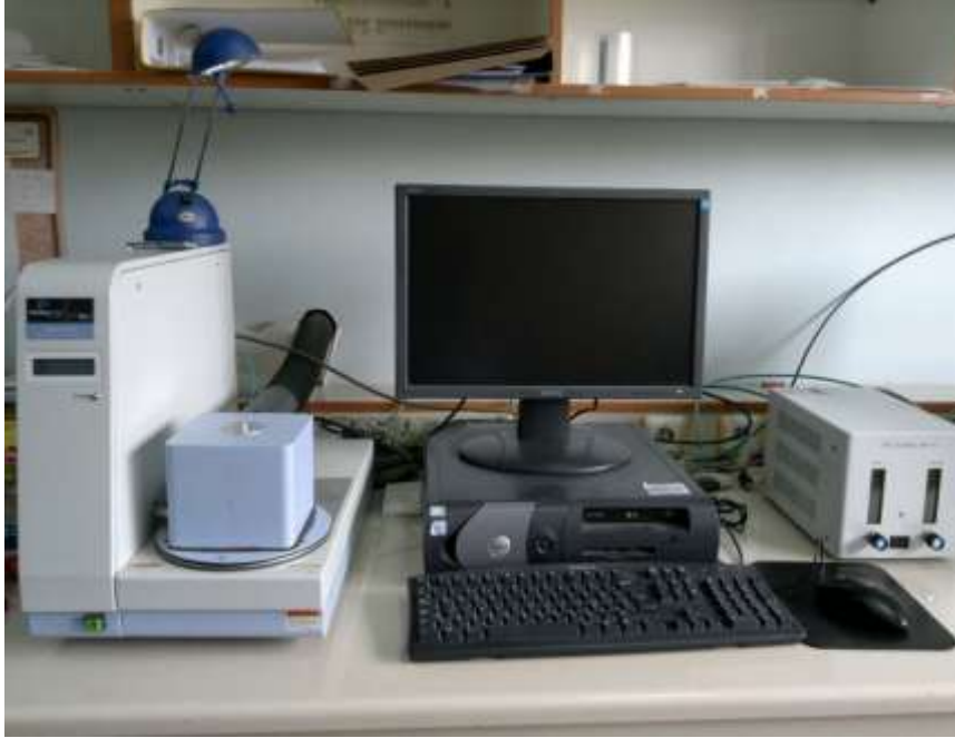
Şekil 5.2. Diferansiyel Taramalı Kalorimetre (DSC) ölçüm sistemi
