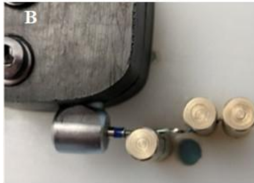
Şekil 2.7. Döner bir eğeyi üç noktada eğilendiren düzenek (Arias ve ark. 2019)
