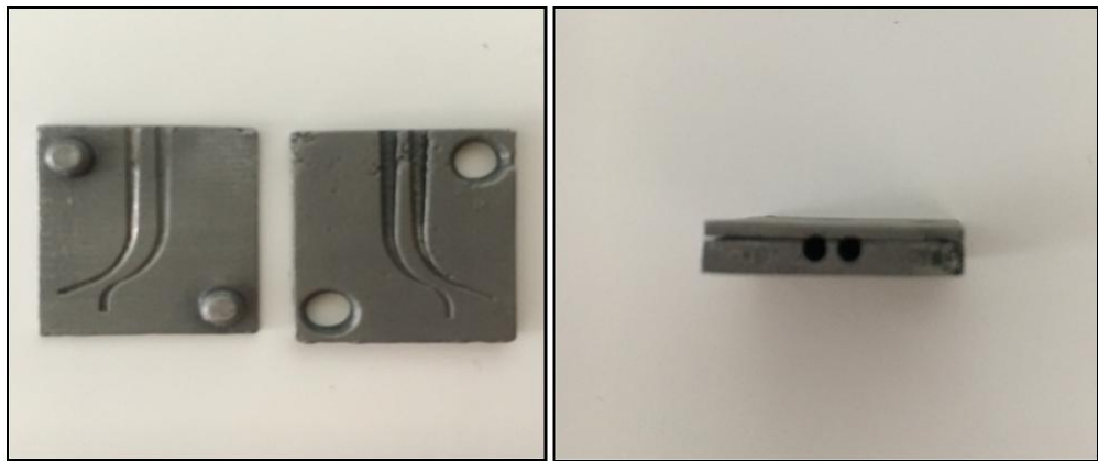
Şekil 3.4. CNC makinalarında üretilen yapay kanalların görünümü
