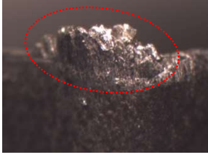
Şekil 7.2. 130 m/dak kesme hızı ve 0,1 mm/ağız ilerlemede oluşan yığıntı talaş.
