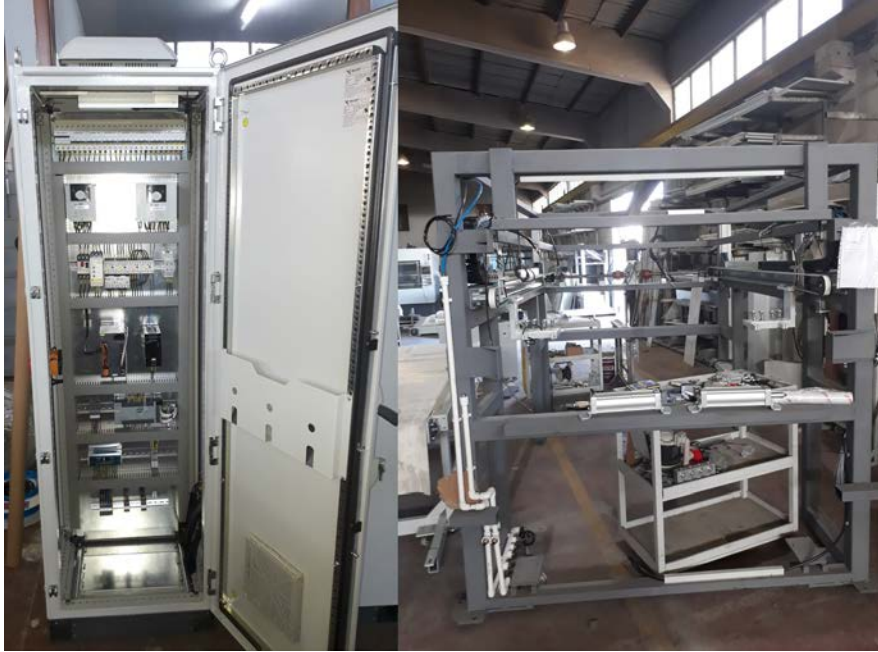
Şekil 2.6. Pano ve şase üzerinde hidrolik/pnömatik montajı
