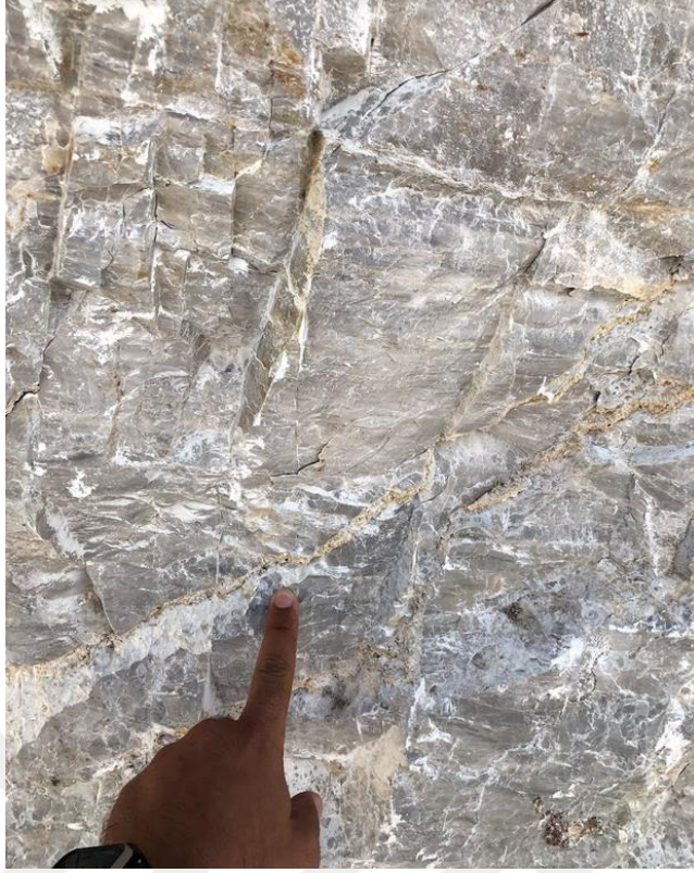
Şekil3.16. Kırıkların etkisi ile yoğun eklemlenme gösteren taze kayaç yüzeyi.
