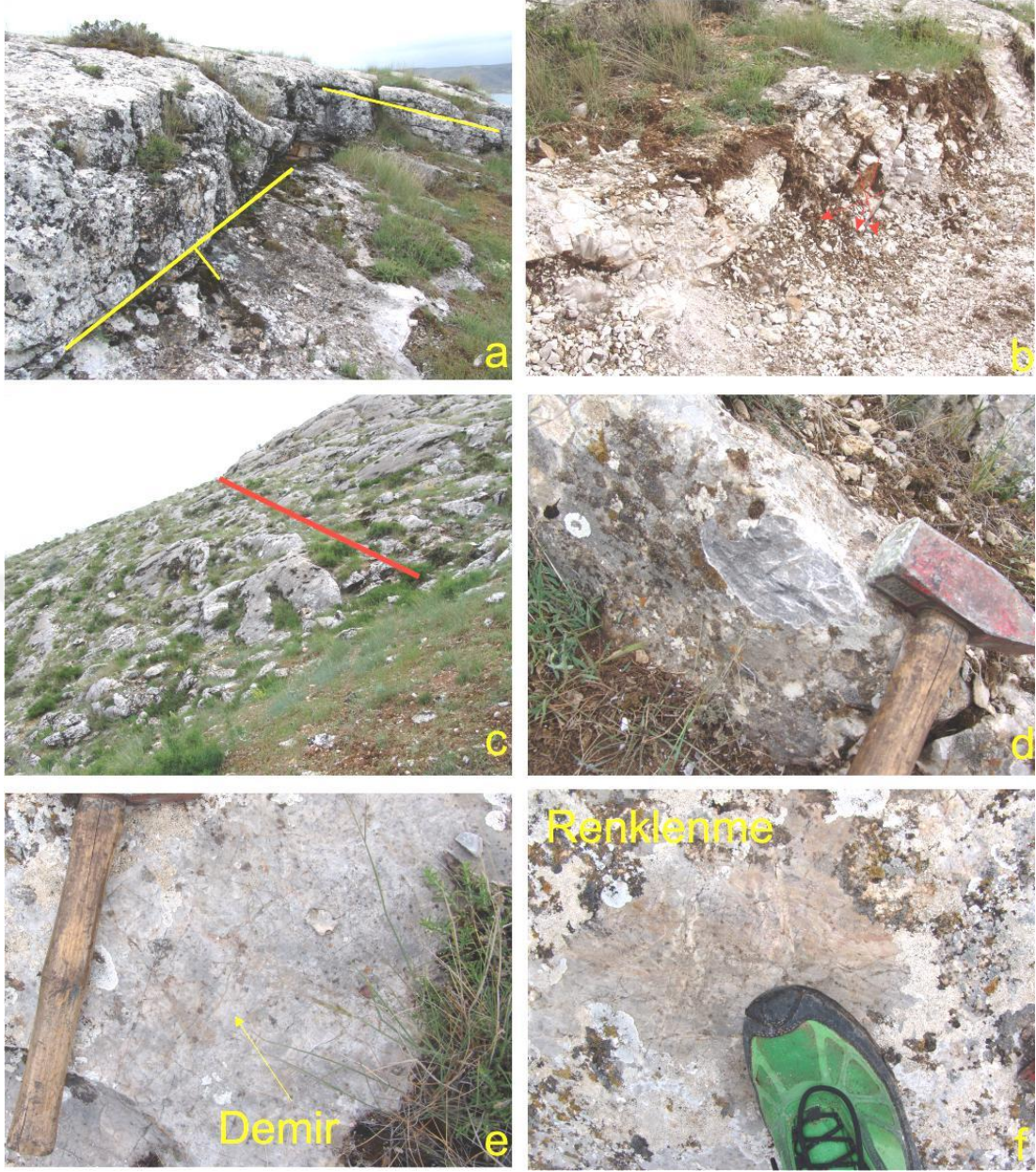
Şekil 33.8. Gri renkli kireçtaşlarının mostra görünüşleri a)tabakalı yapı, b)üst seviyelerde ezik eklemli zon, c)masif yapılar ve açılma kırıkları, d)litolojide hakim gri renk, e)demir girdileri, f)renklenmeler
