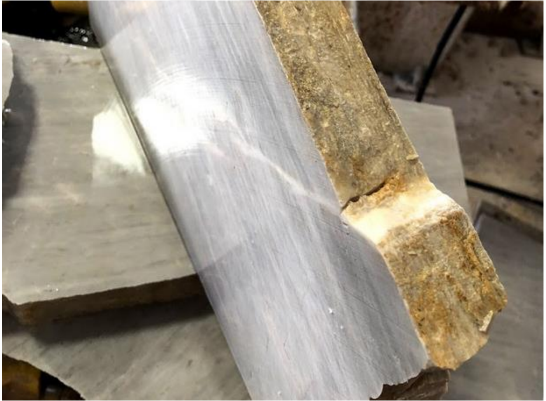
Şekil 3.18. Plaka üretiminde deformasyon etkisi ile oluşan eklemleme ve demirli suların pekleşmeye engel olması ile ortaya çıkan etki
