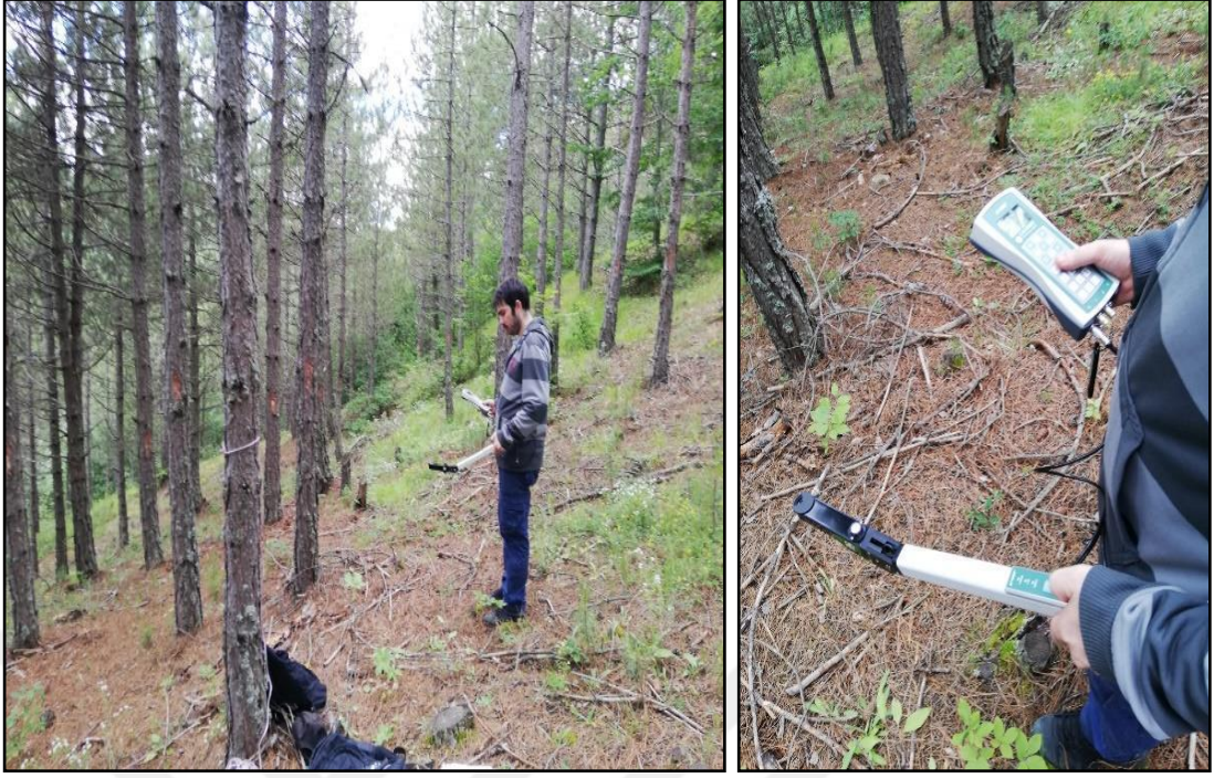
Şekil 2.5 LAI-2200C PCA cihazı ile yapılan ölçümler
