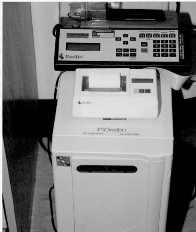
Abb.4: Darstellung des Elektroporationionsgerätes, womit die E.coli Zellen transformiert wurden (Easyject PLUS electropotator, Flowgen Instruments Ltd, UK)
