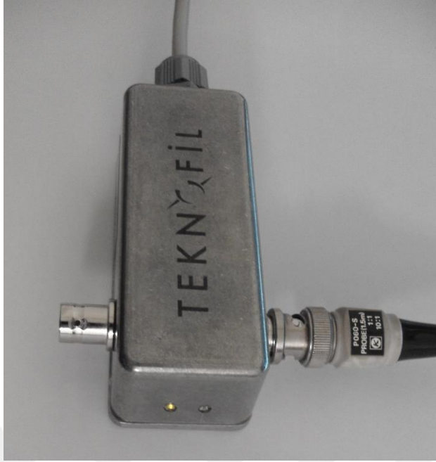
Şekil 3-10: Dalgabiçimi ve tDCS çıkış akımı ölçmek için geliştirdiğimiz nanoScope.
