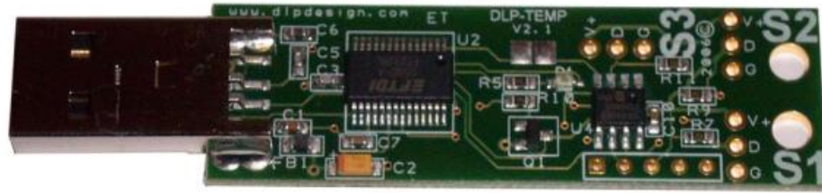
Şekil 3-9: nanoScope için kullandığımız AD dönüştürücü ve USB veriyolu kartı.
