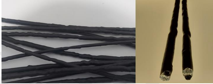
Şekil 3.9 : %10 karbon fiber tozu ile ABS kompozit filament denemesi.
