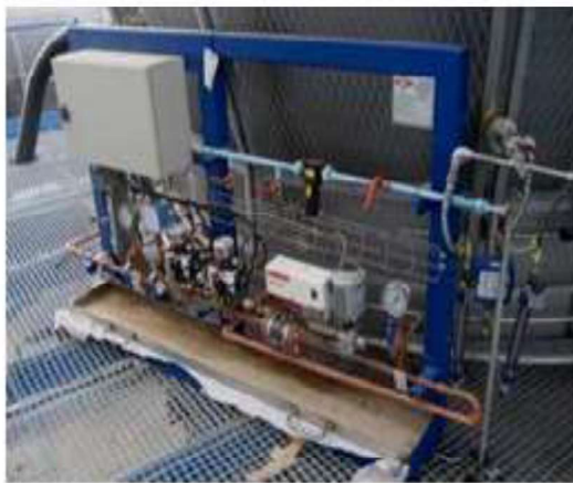
Şekil 3.35. Yatağa yapılan yakıt enjeksiyonu
