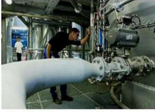
Şekil 3.34. Çamurun fırına enjeksiyonu (beslenmesi)
