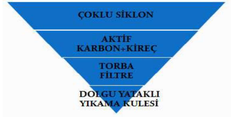
Şekil 3.45. Emisyon Kontrol Sistemi Akış Şeması
