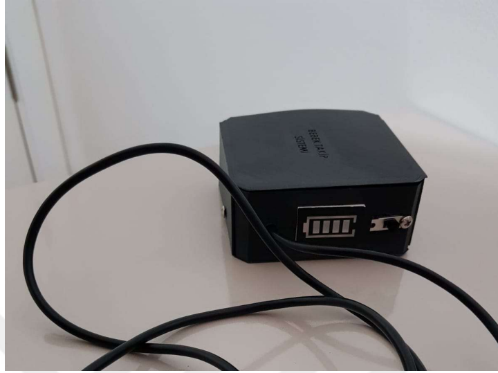
Şekil 3.2 : Tasarlanan sistemin açma kapama ve batarya göstergesi kısmı.
