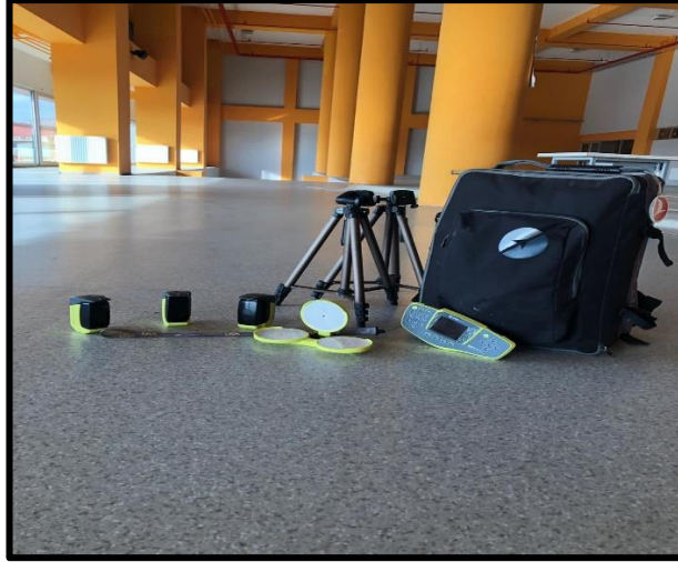
Resim 4. Witty (Microgate, İtalya) Kablosuz Fotosel Sistemi
