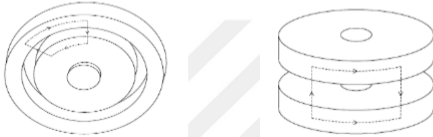
Şekil 2.4. (a) Radyal akılı motor akı yolu, (b) Eksenel akılı motor akı yolu [41]
