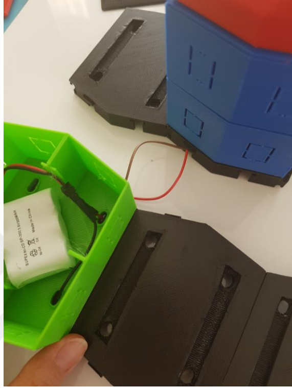
Şekil 60. Zemin modülleri arası bağlantı aktarımı
