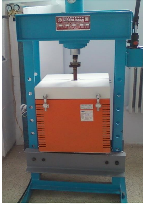
Şekil 19. 40 ton kapasiteli hidrolik pres ve üzerine yerleştirilmiş olan sinterleme fırını (Önal, M. ve Gavgalı, M., 2016; Önal, M., 2010)
