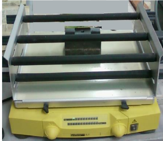
Şekil 18. Üretim kalıbının yerleştirildiği çalkalayıcı
