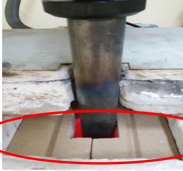
Şekil 20. Isıtma hacmi düşürülmüş fırının görüntüsü
