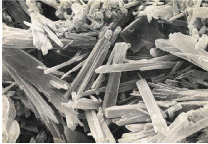
Şekil 1.7 Su eklendikten sonraki jips kristalleri (Gürdal 2010)
