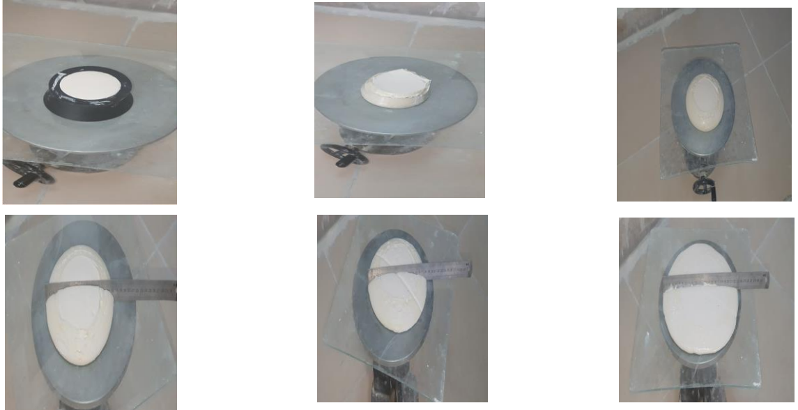
Şekil 4.1 Alçı karışımındaki su ve katkı oranına bağlı olarak oluşan yayılma çapları
