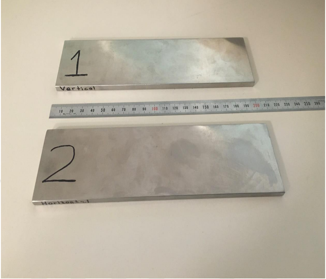
Şekil 7.1. Dikey inşa yönünde üretilen numune(1), yatay inşa yönünde üretilen numune(2)
