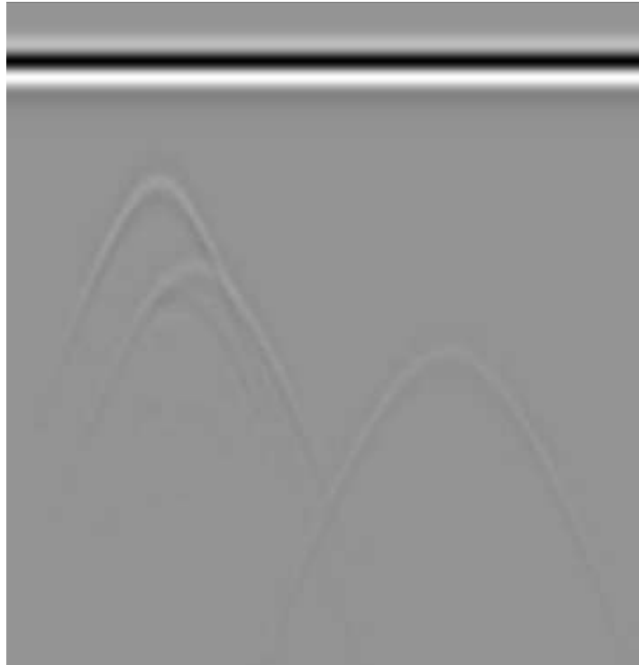
Şekil 4.16 : Ham veri ile eğitilmiş YOLO v3 model çıktısı.
