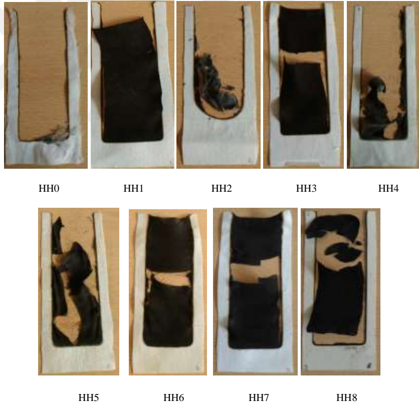
Şekil 3.6: LOI analizi sonrası numunelerin görüntüleri.
