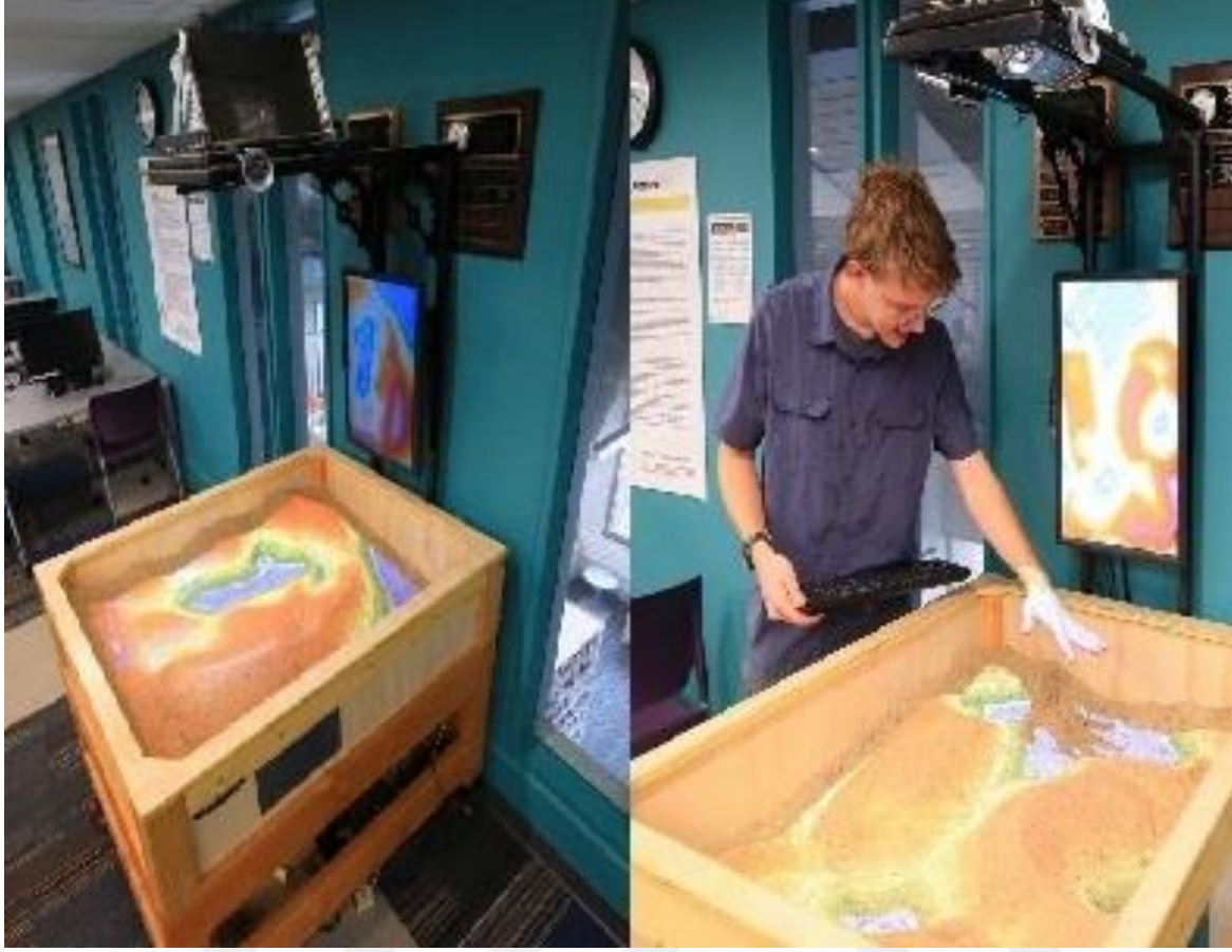
Şekil 9. Yansıtma tabanlı AG örneği ( https://www.usgs.gov/media/galleries/augmented-reality-ar-sandbox-photos )
