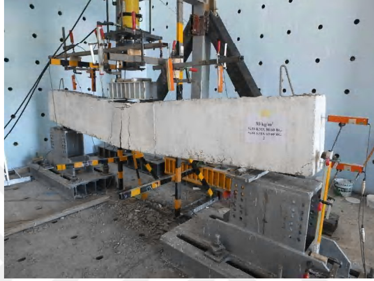
Şekil 3.37. No.6 kirişinin kırılma anı
