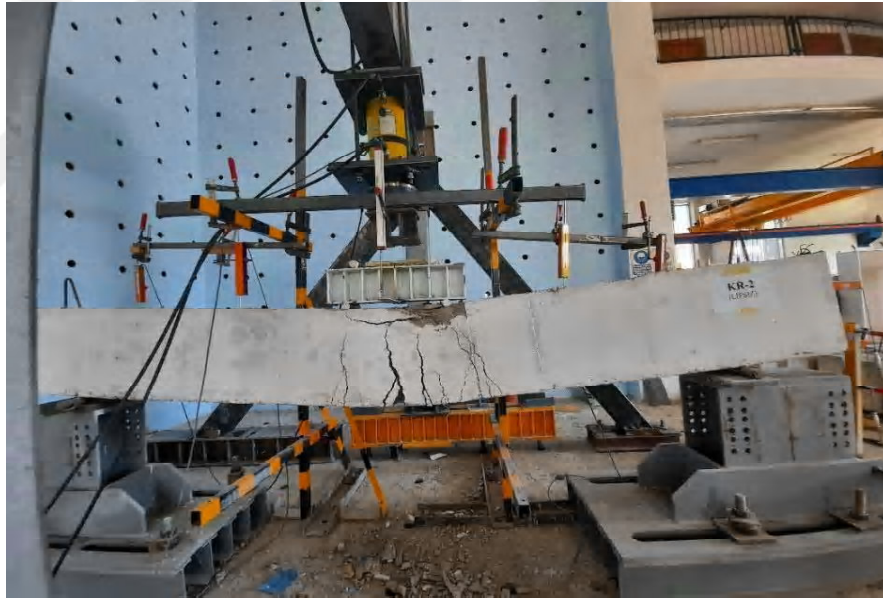
Şekil 3.9. No.2 kirişi kırılma anı
