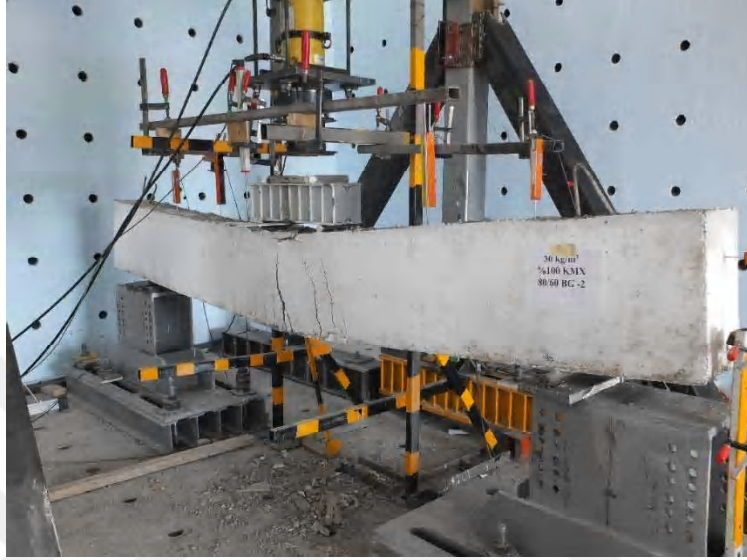
Şekil 3.23. No.4 kirişinin kırılma anı
