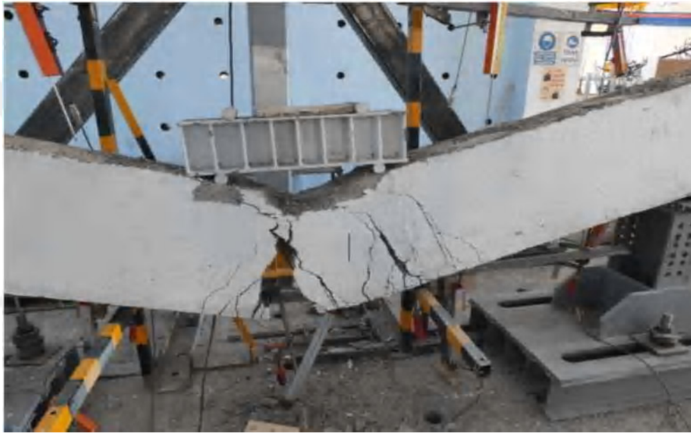
Şekil 2.20. İlk deneydeki kirişin kırılma anı ve zarar gören deplasman ölçüm cihazları
