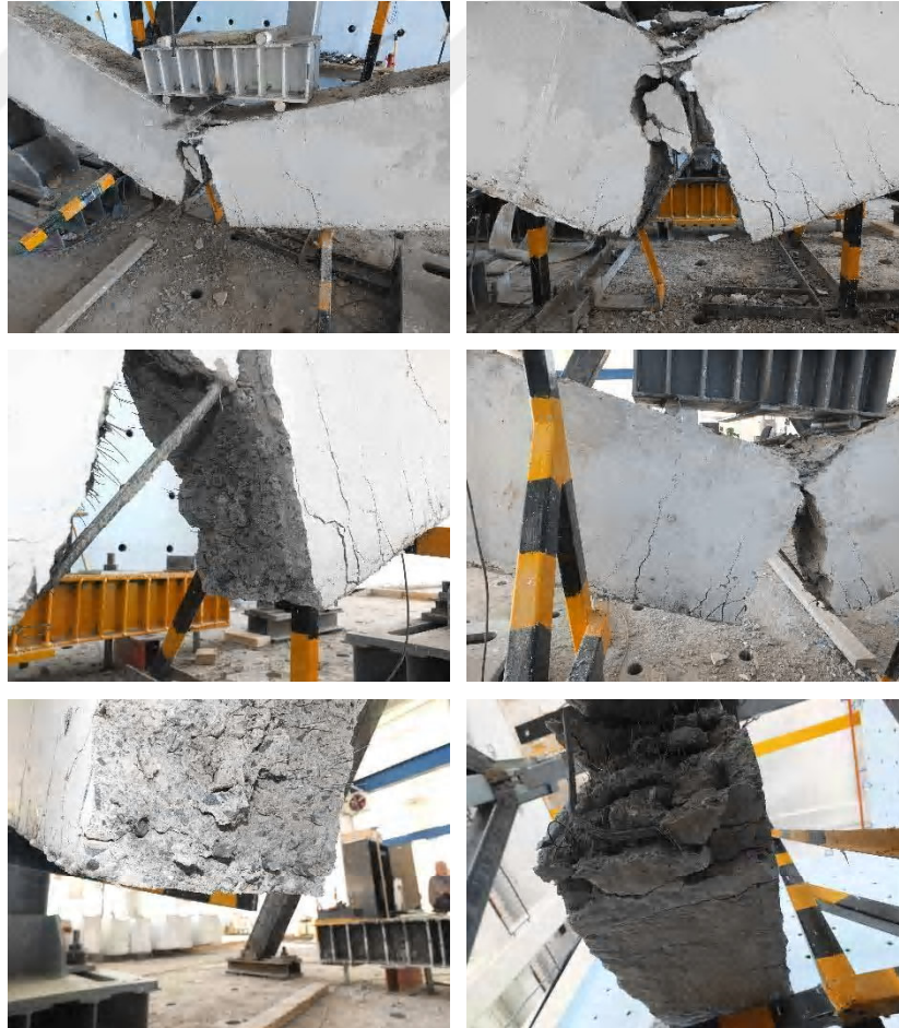
Şekil 3.73. No.11 kirişi hasar oluşumu
