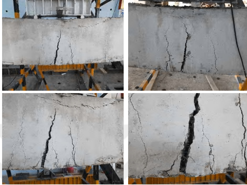
Şekil 3.66. No.10 kirişi hasar oluşumu
