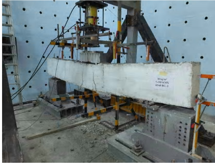
Şekil 3.44. No.7 kirişinin kırılma anı
