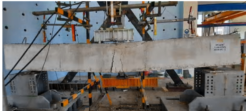
Şekil 3.65. No.10 kirişinin kırılma anı
