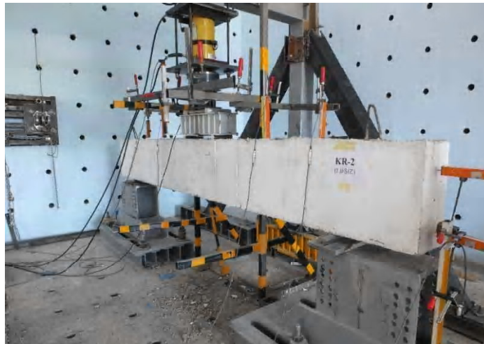
Şekil 3.8. No.2 kiriş numunesinin deney öncesi görünümü
