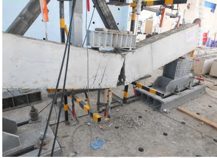
Şekil 3.16. No.3 kiriş numunesinin kırılma anı
