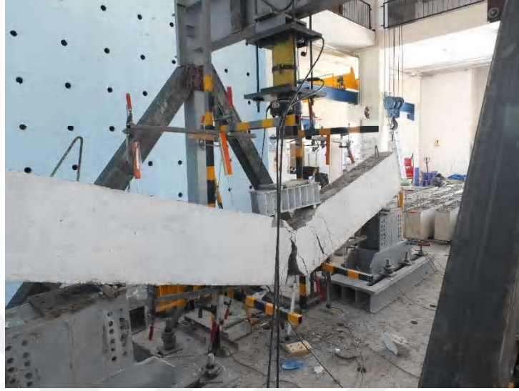
Şekil 3.2. No.1 kirişi kırılma anı
