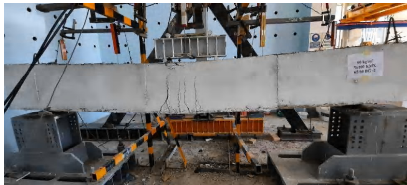
Şekil 3.93. No.14 kirişinin kırılma anı
