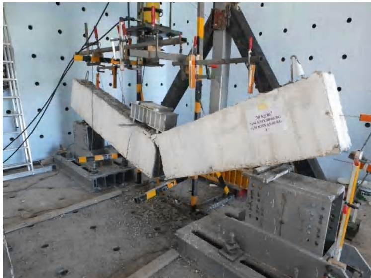
Şekil 3.30. No.5 kirişinin kırılma anı
