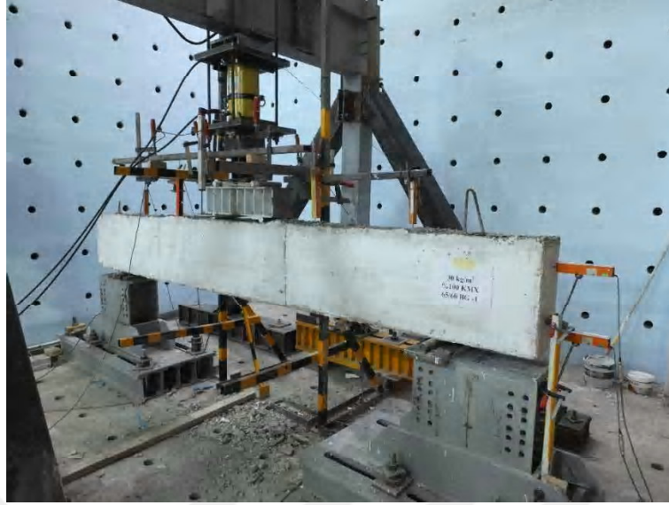
Şekil 3.43. No.7 kirişinin deney öncesi görünümü
