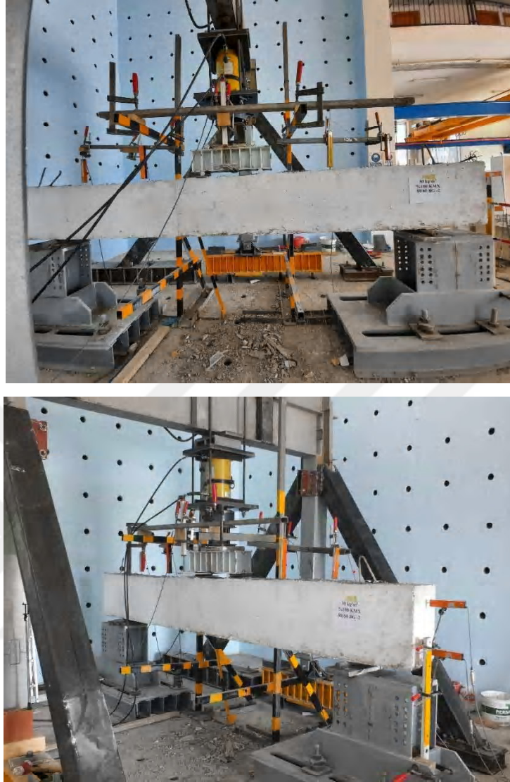
Şekil 3.22. No.4 kirişinin deney öncesi görünümü
