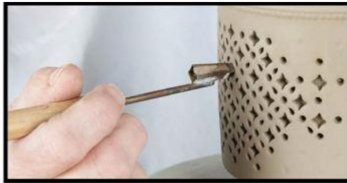
Şekil 10. İçerisinde Lastik Model Bulunan Forma Ajur Dekorunun Uygulanması (Gökçe, 2011)
