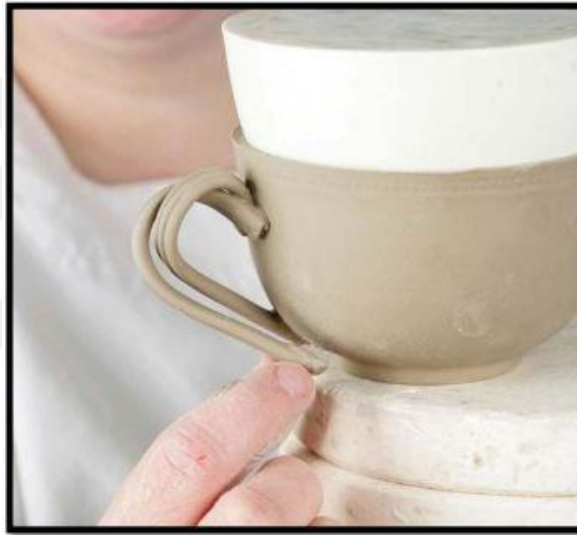
Şekil 9. Ajur Dekor Uygulanmadan Önce Formun İçine Lastik Modelin Yerleştirilmesi ve Formun Şekillendirilmesinin Tamamlanması (Gökçe, 2011).
