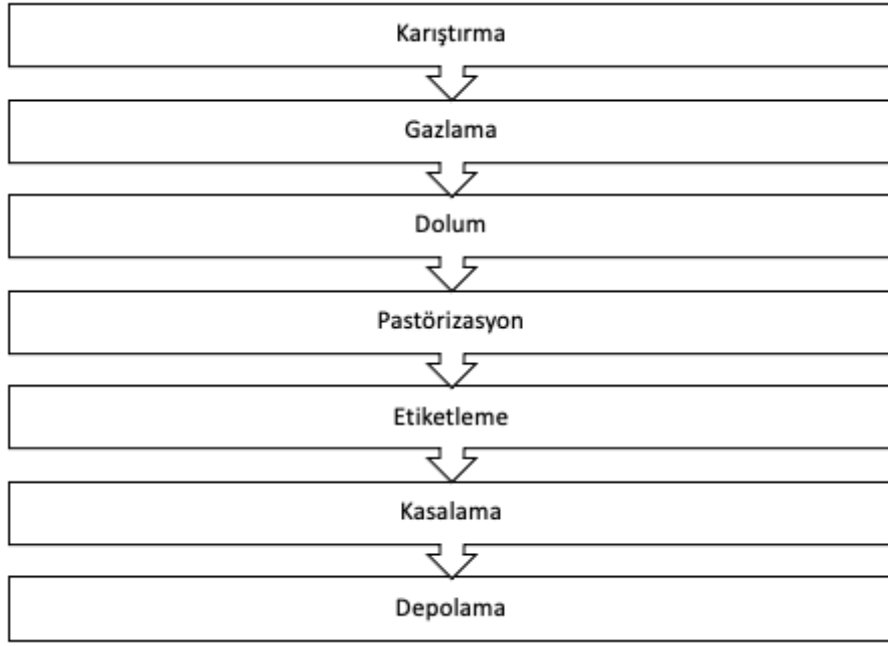
Şekil 4.2 : Meyve ve meyve aromalı doğal mineralli gazlı içeceklerin üretimi.
