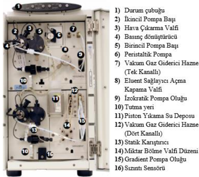
Şekil 3.10 : Çift pompanın iç bölmesinde bulunan mekanik bileşenler [18].
