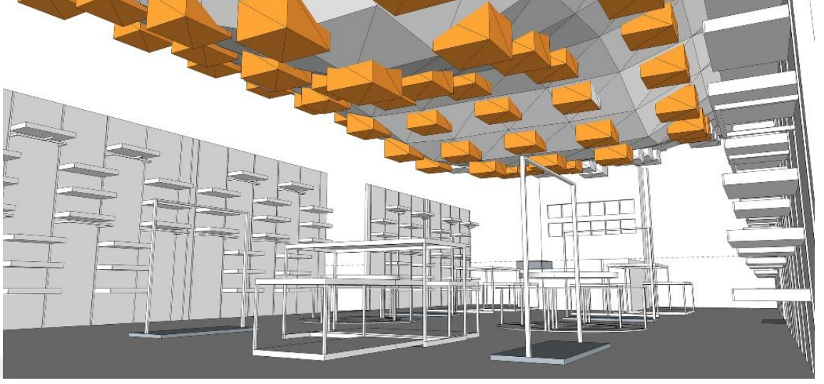
Şekil 51. Yüzey aydınlatma elemanlarının yerleştirilmesi
