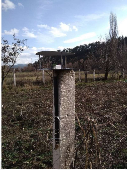
Şekil 3.1. Durham cihazı ve yerleştirildiği yer.
