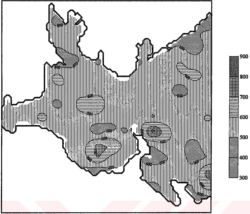
Şekil.3.5.c) Çeşme 50 m enerji potansiyel dağılışı, ( W/m^2 )
