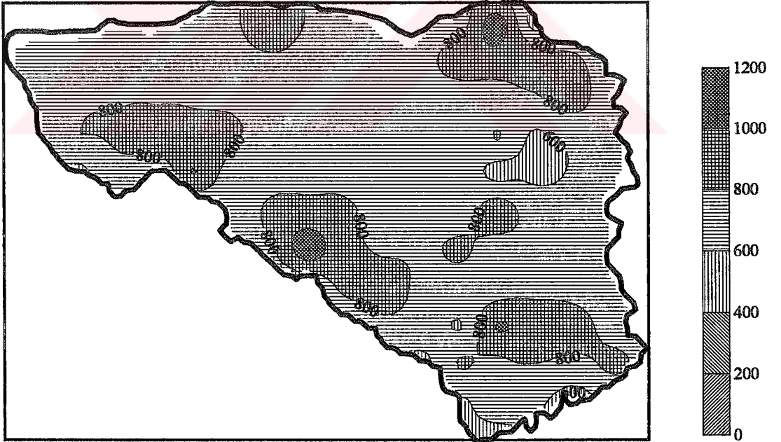
Şekil.3.4.b) Bozcaada 25 m enerji potansiyel dağılışı, ( W/m^2 )
