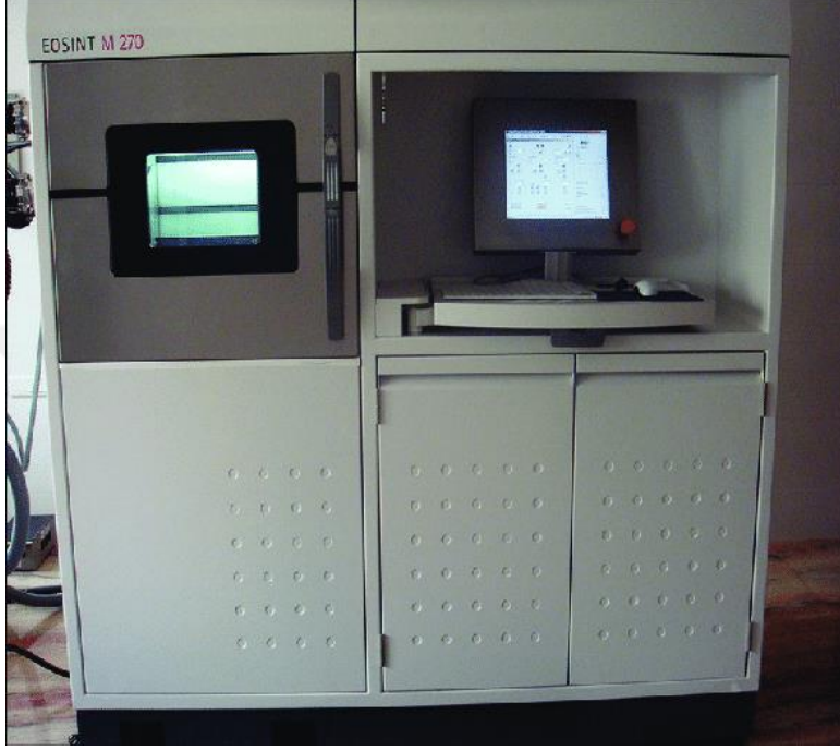
Şekil 3.6. Üretimin gerçekleştirildiği Eosint M270 sistemine ait lazer sinterizasyon cihazı
