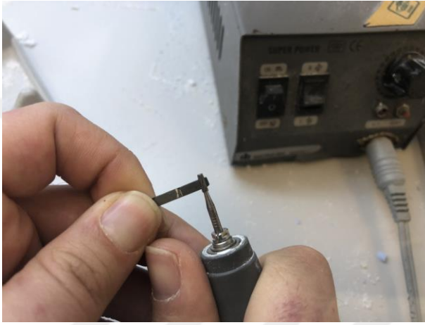
Şekil 3.3. Döküm kanallarının kesilip metal yüzeyinin tungsten karbid frezlerle aşındırılması
