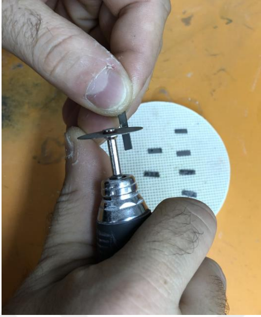
Şekil 3.8. Metal altyapıların kesilmesi
