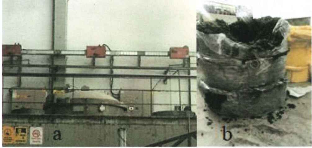
Şekil 2.11 Geri Dönüşüm Pamuk Boyama İşlemi (a) Boya Kazanı (b) Boyanmış Haldeki Elyaf
