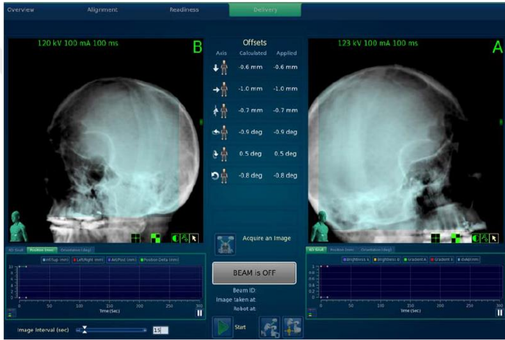
Şekil 9. 6D Skull izleme algoritması (Accuray Inc., 2018)
