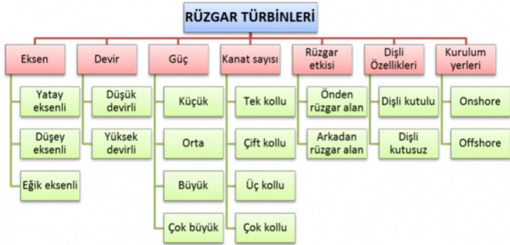
Şekil 5.4. Rüzgâr türbinlerinin sınıflandırılması (Elibüyük, 2016)
