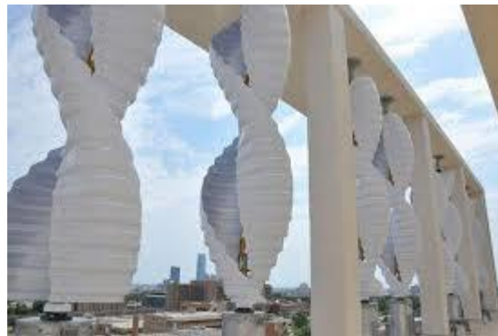
Şekil 5.9. Savonius Tipi Rüzgâr Türbini (Işık, 2015).
