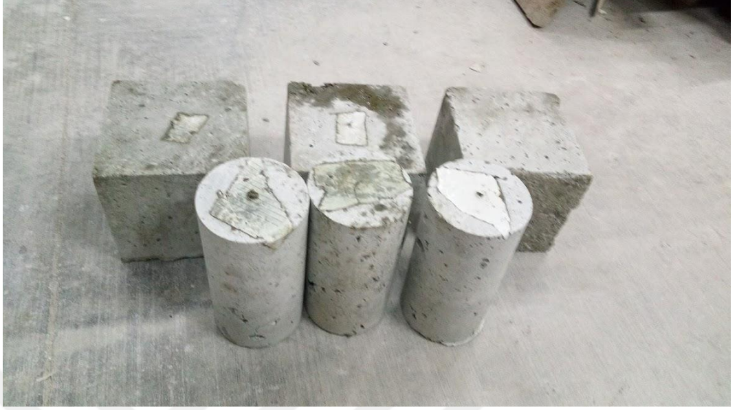
Şekil 3.4 Beton küp numuneler
