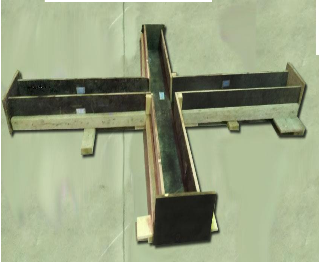
Şekil 3.8 Hazırlanan deney kalıbı
