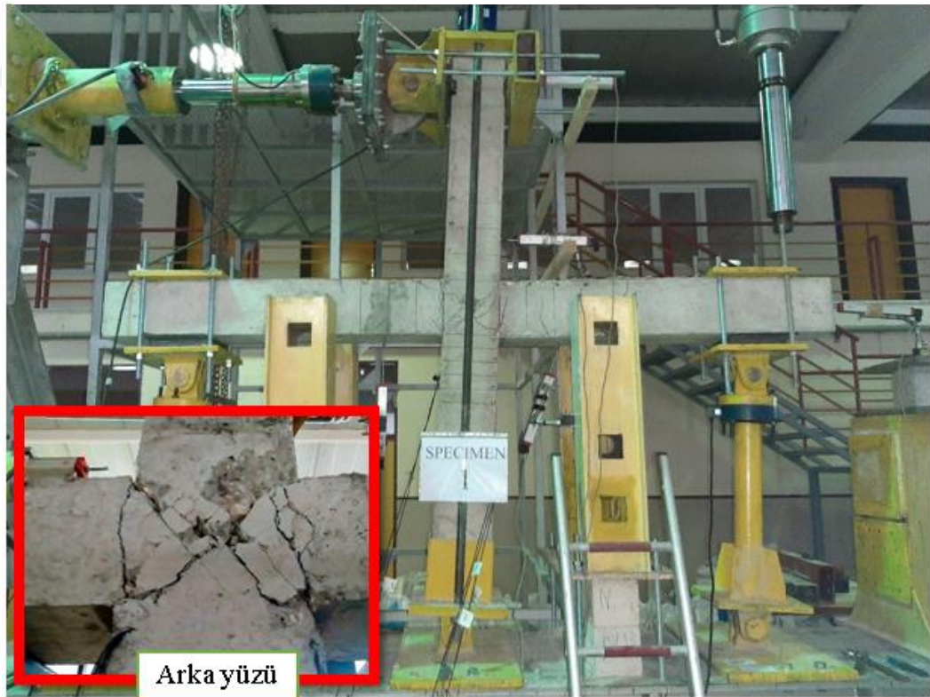
Şekil 5.4 Deney sonunda referans betonarme birleşim elemanında meydana gelen hasar (R1)
