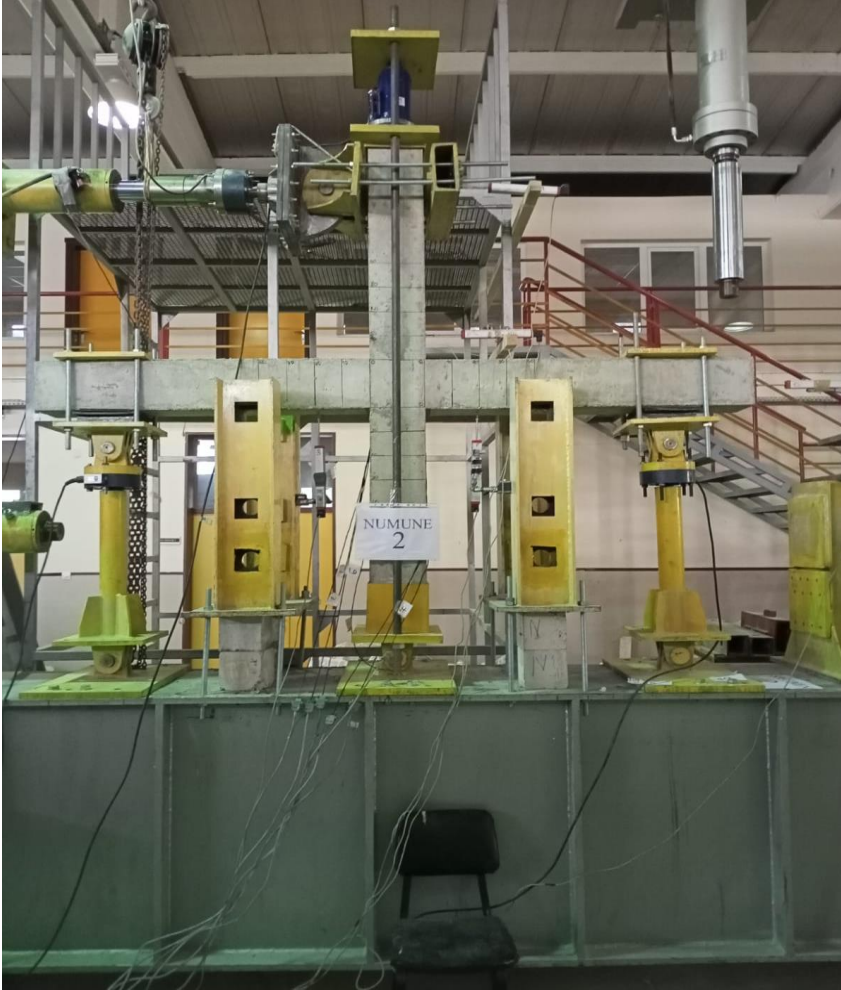
Şekil 5.6 Kompozit birleşim elemanı (R2) deney düzeneği
