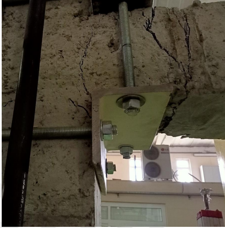
Şekil 5.14 Deney sonunda elemanda meydana gelen hasar
