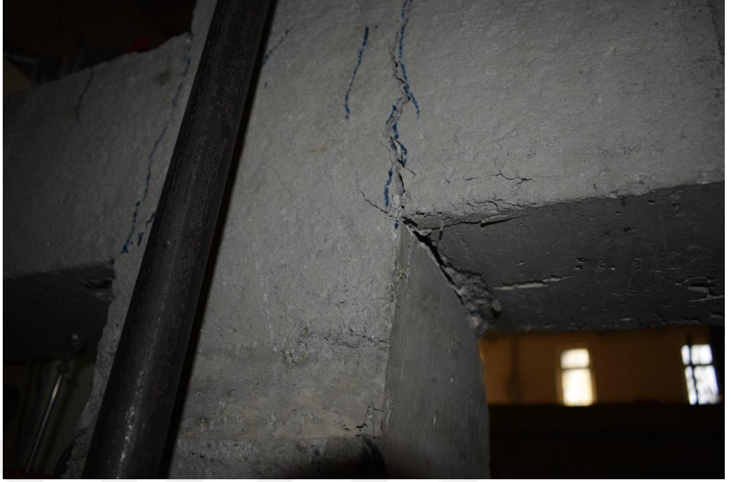
Şekil 5.9 Deney sonunda elemanda meydana gelen hasar
