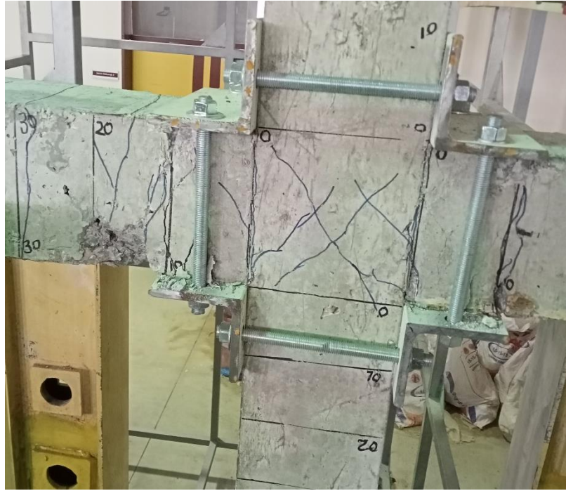
Şekil 5.15 Deney sonunda elemanda meydana gelen hasar
