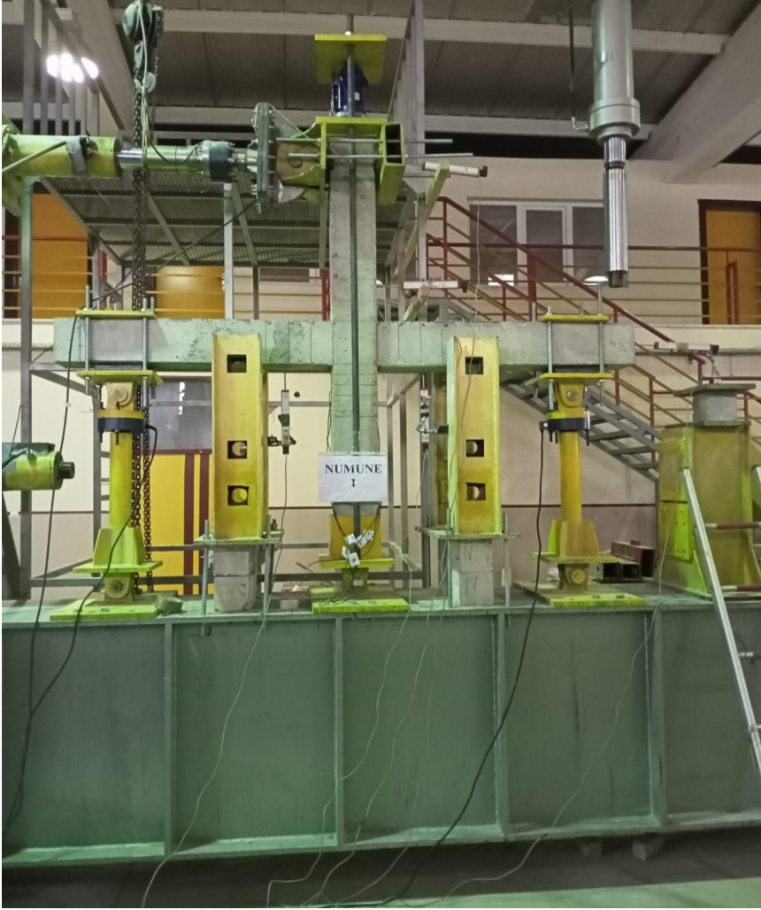
Şekil 5.1 Referans betonarme birleşim elemanı (R1) deney düzeneği
