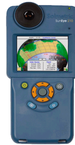
Şekil 7.2. Suneye gölge ölçüm cihazı.(solmetric, 2020)
