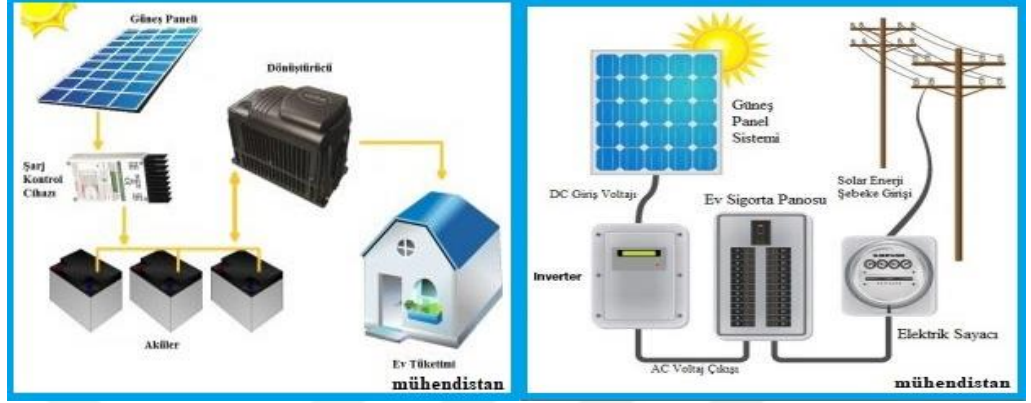
Şekil 4.13. Şebeke bağlantılı ve bağlantısız sistem elemanları. (mühendistan.com, 2020)
