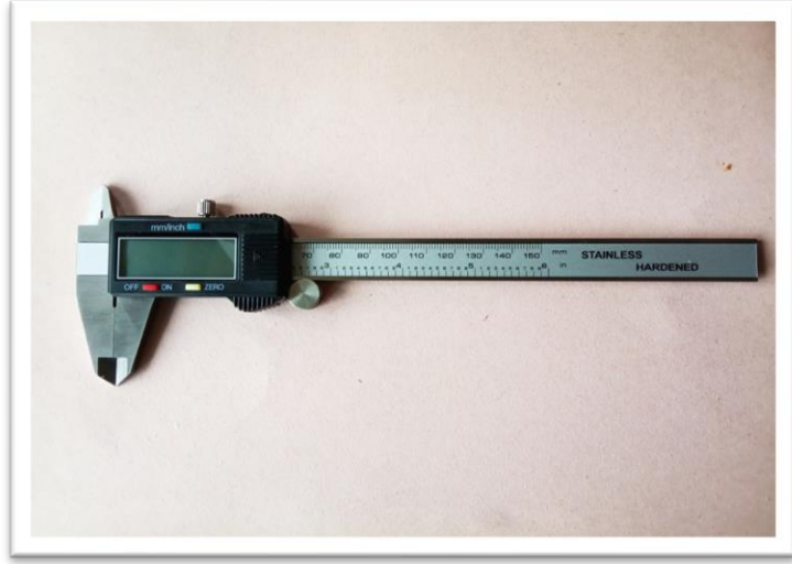
Şekil 3.1: Ölçüm amacıyla kullanılan, ölçüm aralığı 0,150 mm, çözünürlüğü 0,1mm olan AEK-Tech model dijital kumpas.
