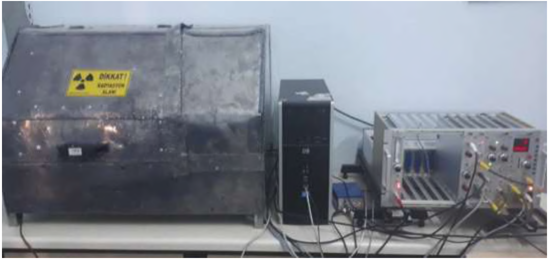
Resim 5.3. Hitit Üniversitesi Fen Edebiyat Fakültesi Fizik Bölümü Mössbauer Spektrometresi cihazı
