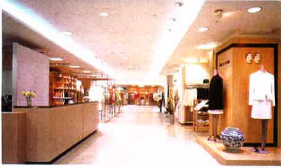
Şekil 4.1.11 Bir teşhir mekanında tavana uygulan gizli aydınlatma armatürleri
