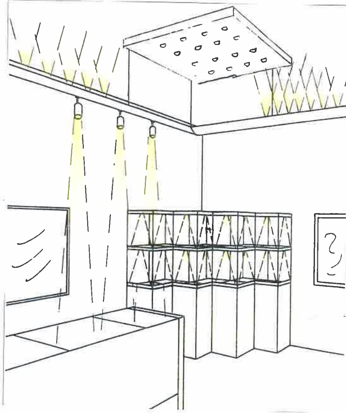
Şekil 4.3.4.2 Mücevherat mağazalarının Satış Mekanlarının aydınlatması
