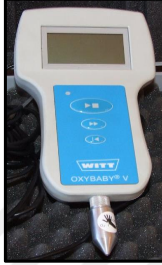
řekil 3.18. Arařtırmada kullanılan paket ii gaz lm cihazı (orijinal)
