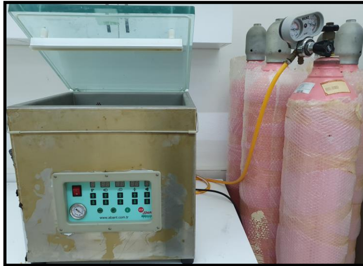
Şekil 3.17. Araştırmada kullanılan modifiye atmosfer paketleme makinesi (orijinal)
