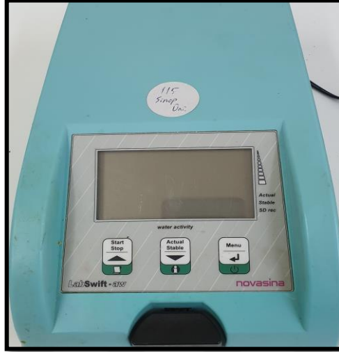
Şekil 3.20. Araştırmada kullanılan su aktivitesi ölçüm cihazı (orijinal)
