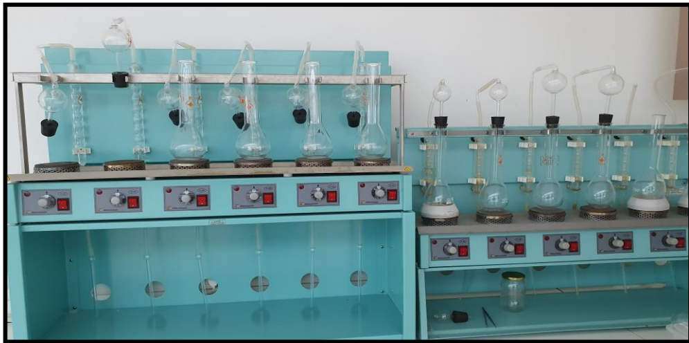
Şekil 3.9. Araştırmada kullanılan TVB-N destilasyon ünitesi (orijinal)
