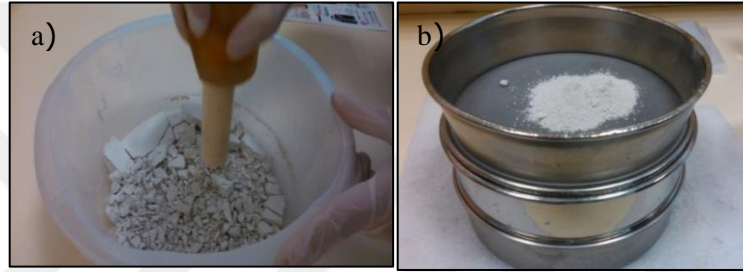
Şekil 3.4:a) Granül haline getirme işlemi, b) Kullanılan elekler.
