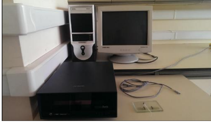
Şekil 3.7: Elastik modül ve frekans ölçümü için kullanılan Grindo-Sonic® marka Mk5 model cihaz.
