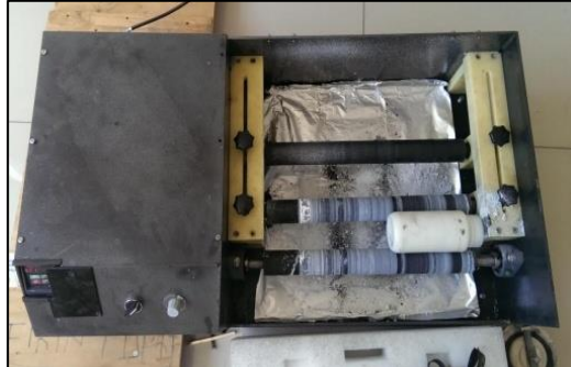
Şekil 3.1:Öğütme işleminde kullanılan bilyalı değirmen.
