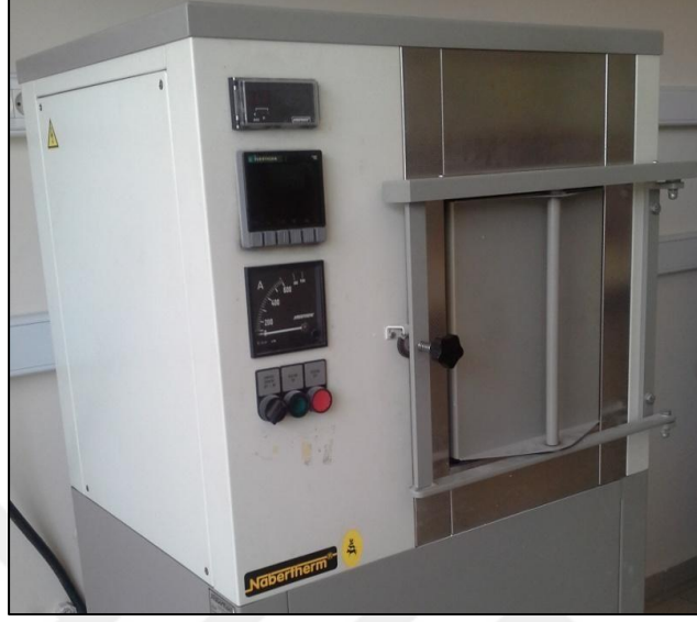
Şekil 3.6:Sinterleme için kullanılan Nabertherm marka laboratuvar tipi elektrik ısıtmalı kutu fırın.
