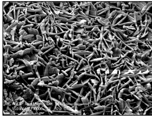
Şekil 2.3: Toz pomza mineralinin SEM mikroyapı görüntüleri.
