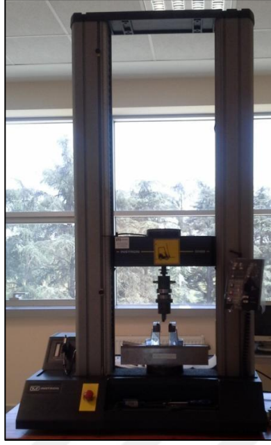
Şekil 3.8:Eğme mukavemeti hesaplaması için kullanılan 5569 model Instron test cihaz.
