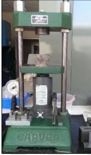
Şekil 3.5:Şekillendirme sırasında kullanılan Carver marka hidrolik pres.
