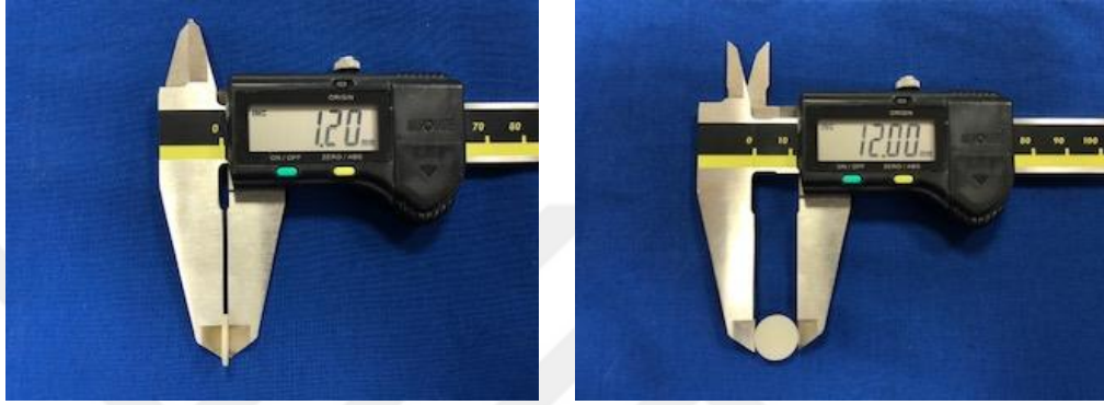
Şekil 3.7. Sinterleme sonrası örneklerin boyutu.
