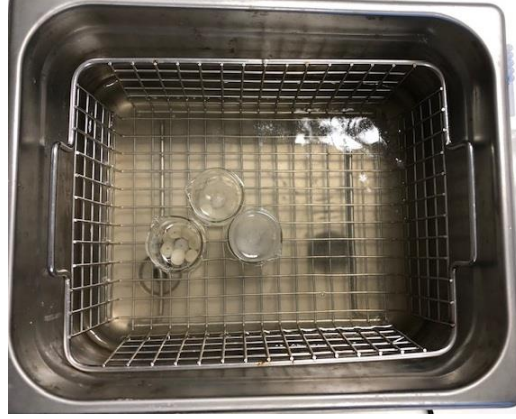
Şekil 3.10. Örneklerin ultrasonik banyoda temizlenmesi.
