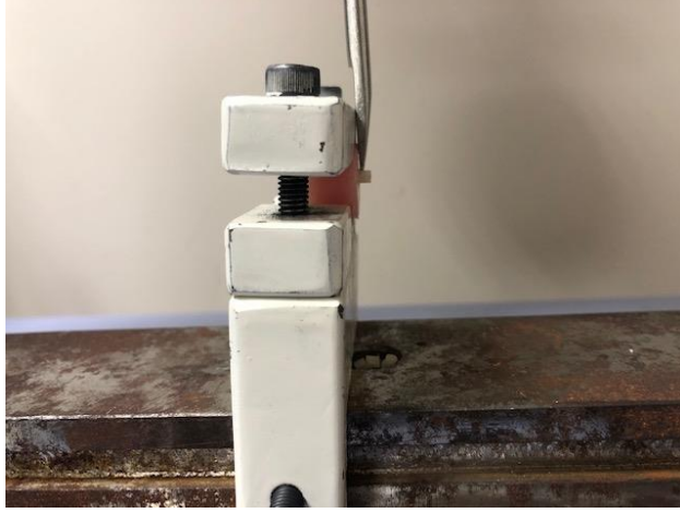
Şekil 3.13. Örneklere makaslama bağlanma dayanımı testi uygulanması.
