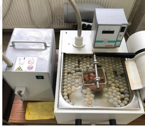
Şekil 3.12. Örnekler termal siklus uygulanması.
