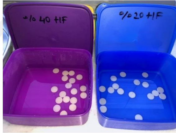
Şekil 3.9. Örnekler plastik kutu içerisinde HF uygulanması.
