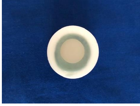
Şekil 3.8. Kumlama için hazırlanan silikon indekse yerleştirilen örnek.
