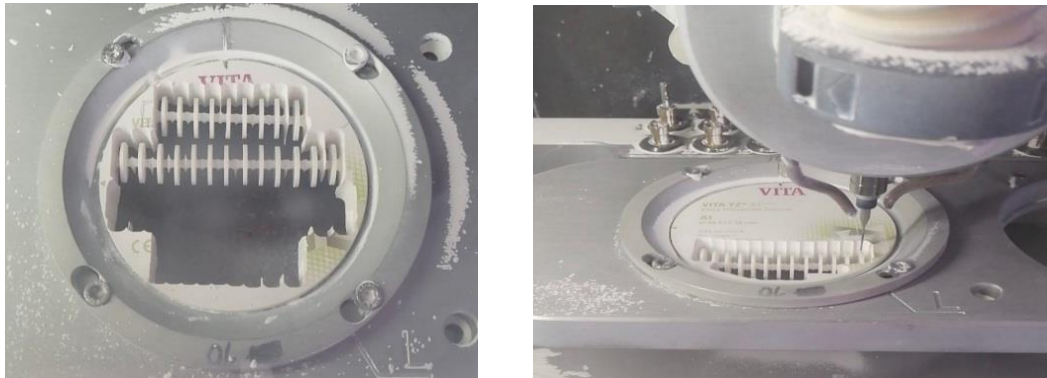
Şekil 3.4. Monolitik zirkonya blokların frezelenmesi.
