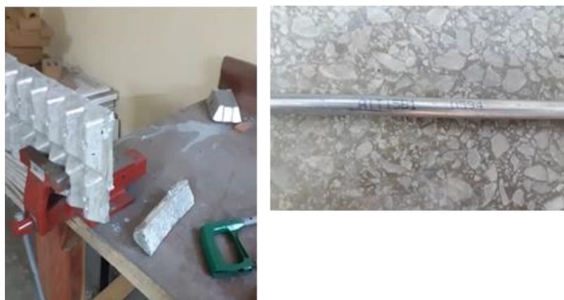
Şekil 3.1 Alaşımlama için kullanılan Al-5V, Al-10Zr külçeleri ve Al-5Ti-1B çubuğu.
