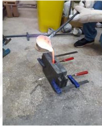
Şekil 3.4 Isıtılmış kalıba döküm işlemi.
