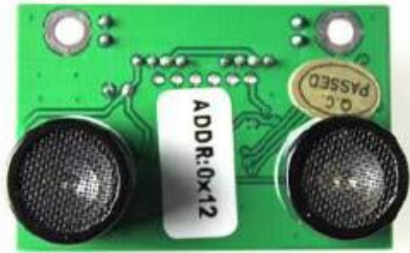
Şekil 3.8. Ultrasonik sensör (Anonymous, 2019)
