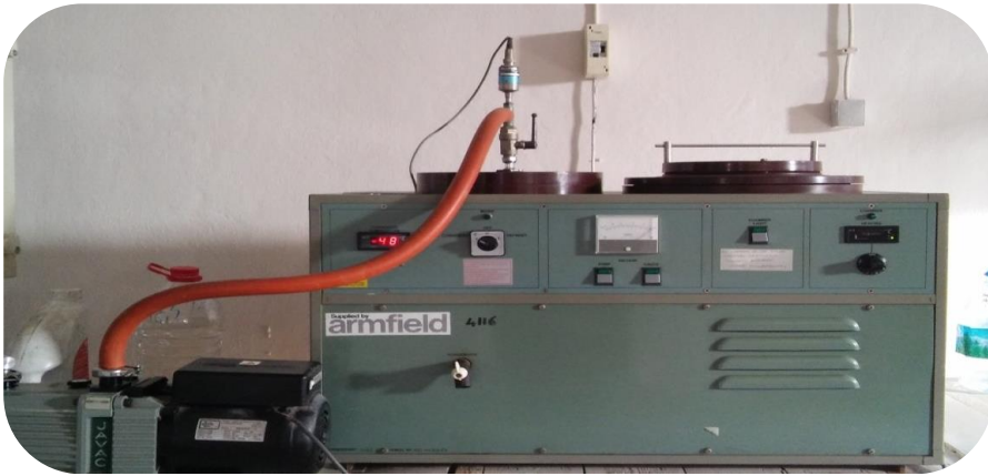
Şekil 3.8. Armfield FT 33 Vacuum Freeze Drier markalı pilot ölçekli dondurarak kurutucu.
