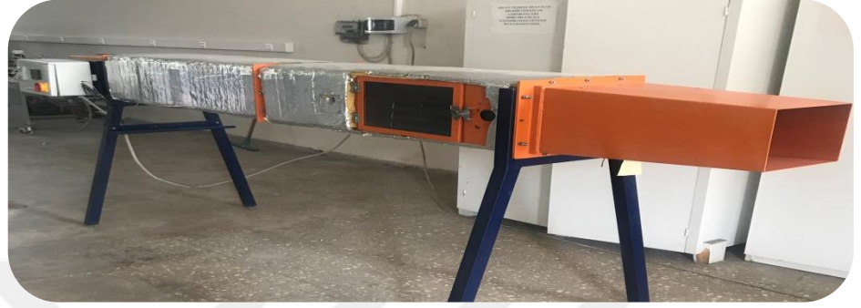
Şekil 3.6. Armfield Lim., Ringwood, Hampshire markalı pilot ölçekli tepsili kurutucu.
