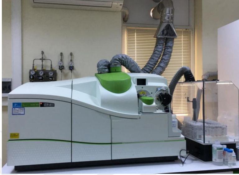
Şekil 2.75. Perkin Elmer ® ICP Mass Spectrometer 300 X
