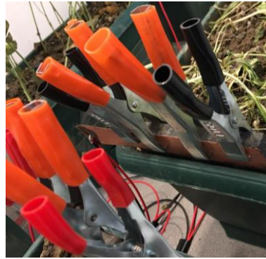
Şekil 2.32. Metal mandallar ile bakır levhaların elektrotlara tutturulması
