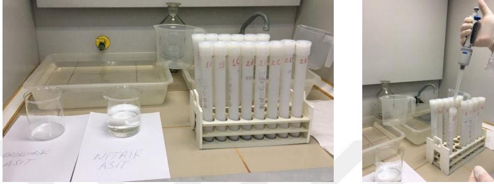
Şekil 2.67. Numunelere asit ilavesi
