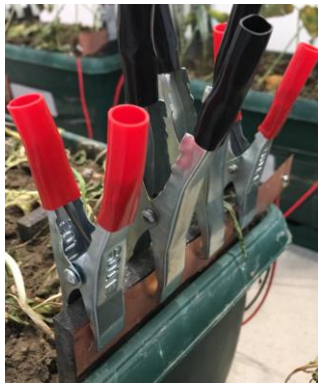
Şekil 2.32. Metal mandallar ile bakır levhaların elektrotlara tutturulması
