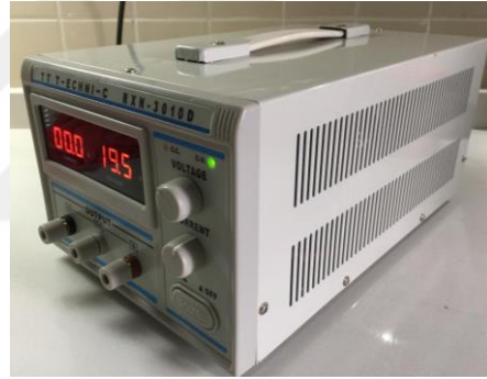
Şekil 2.31. Voltaj uygulamasında yararlanılan DC güç kaynağı
