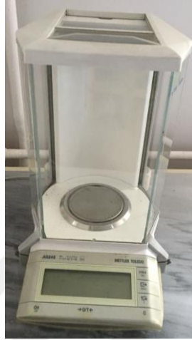
Şekil 2.60. Mettler Toledo AG245 hassas terazi
