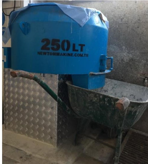
Şekil 2.11. Toprağın karıştırılmasında kullanılan betoniyer makinası
