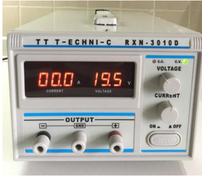
Şekil 2.31. Voltaj uygulamasında yararlanılan DC güç kaynağı
