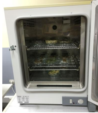
Şekil 2.63. Deiyonize su ile yıkanmış bitkilerin etüvde kurutulması
