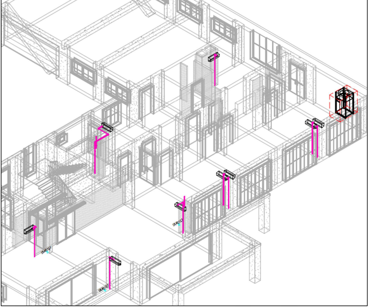
Şekil 5.8 : Zemin kat için VRF sisteminin projesi.
