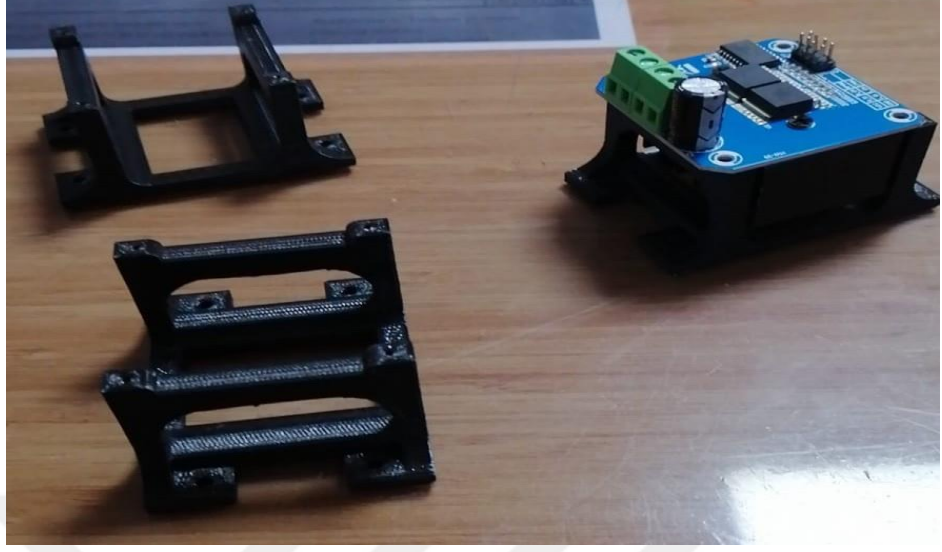
Şekil 3.23. Motor sürücülerin izolasyonu için 3 boyutlu yazıcıdan alınan baskılar.
