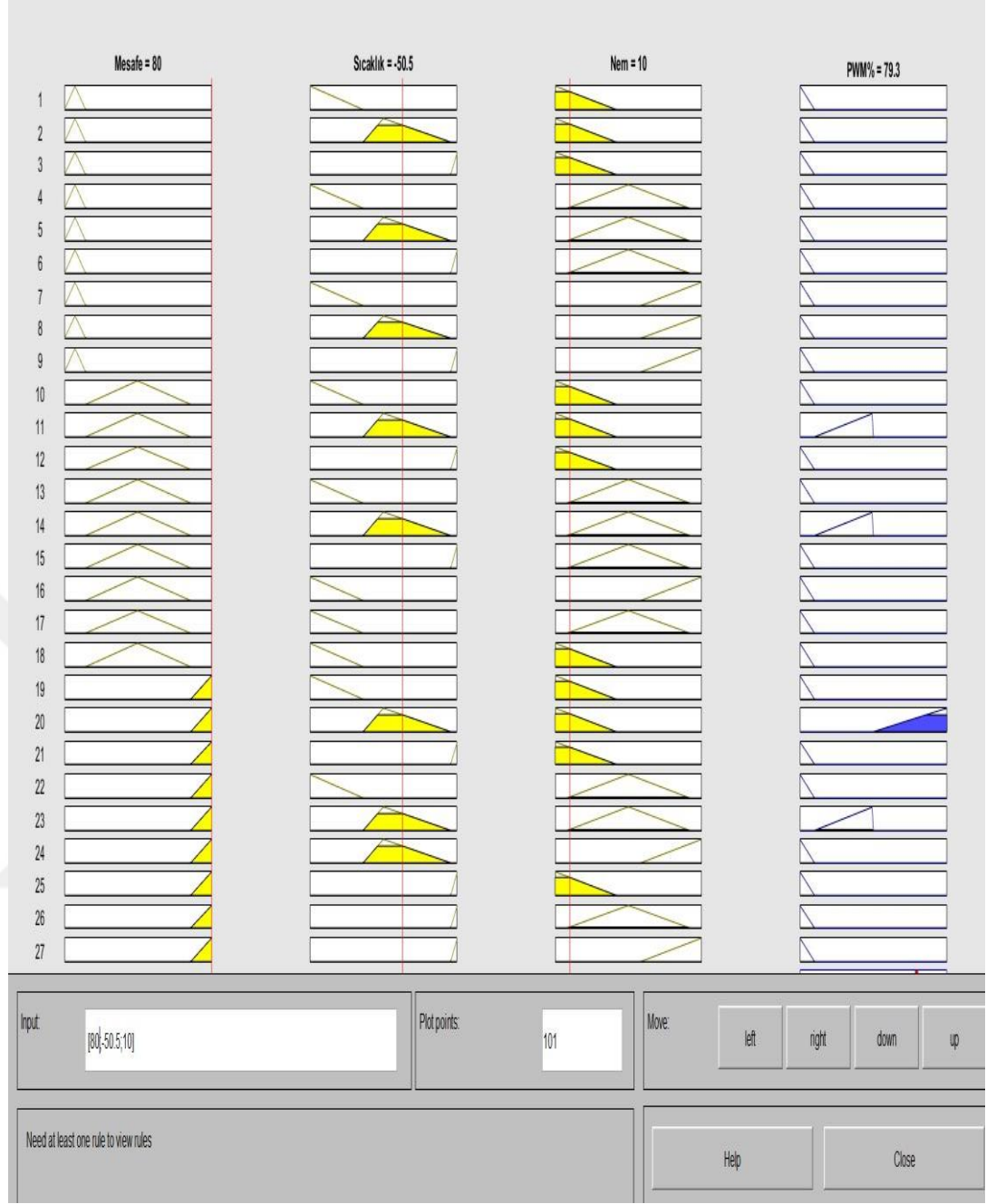
Şekil 3.20. Rover hız kontrol sistemi, engelle 80 cm uzaklıkta, -50,5^{\circ} sıcaklıkta ve %10 nemli havada hız çıktısı.
