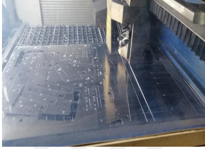
Şekil 3. 11. Lazer makinasında kesilen alüminyum levha.
