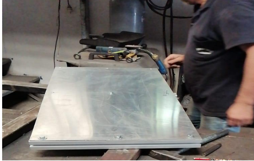
Şekil 3. 16. 2 mm alüminyum levhadan hazırlanan mobil robotun şasesi.
