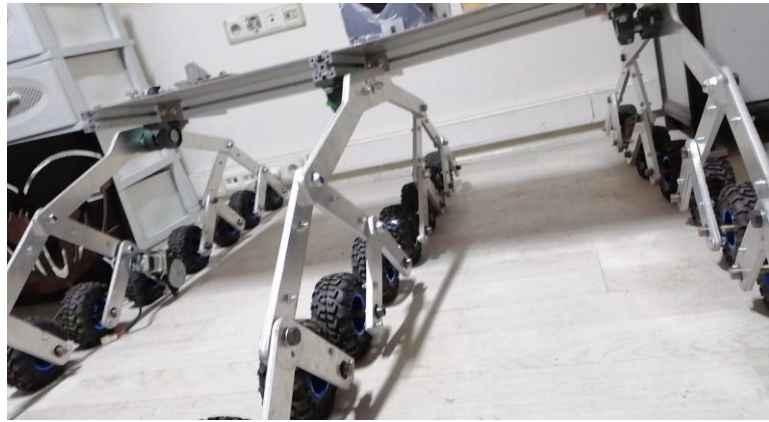
Şekil 3. 12. Sistemin 3 kademeli olarak tasarlanan modelinin ilk mekanik montajına ait resim.
