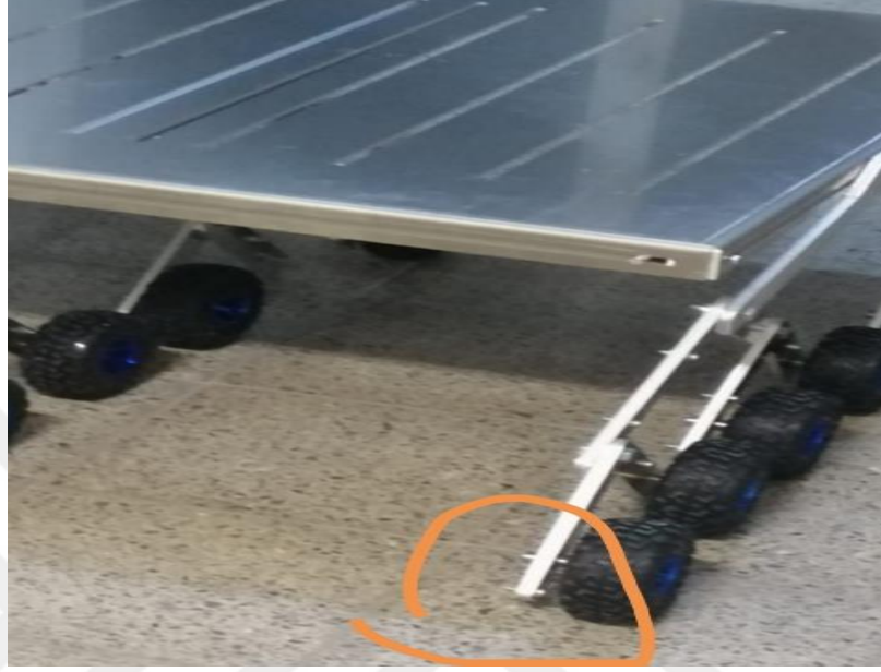
Şekil 3. 13. Sistemin hareketi sırasında engebeli arazide hareketine engel olan uzvu.
