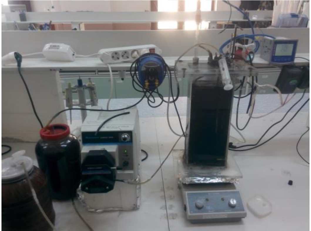
Şekil 3.4. ÇSS arıtımında kullanılan AeMBR fotoğrafı
