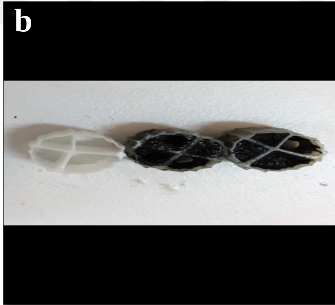
Şekil 4.13. Farklı işletme koşulları altında AnoxHYBR’de Kaldness K1 taşıyıcı materyal üzerindeki biyofilm konsantrasyonu (a) ve biyofilm fotoğrafı(b)
