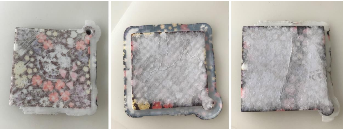
Görsel-48: PLA filamenti üzerine kağıttan transfer baskı. Soldan sağa 150 °C 10", 120 °C 20", 180 °C 10"
