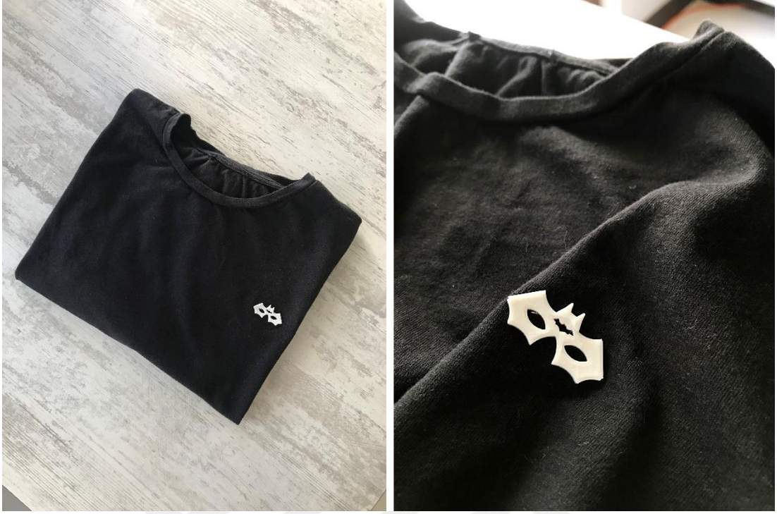
Görsel-50: Pamuk penye tişört üzerine PLA filamenti ile 3B Batman logo baskı.
