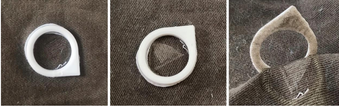
Görsel-26: Soldan sağa; baskı sonrası, yıkama sonrası, ters yönde kuvvet uygulandıktan sonra.
