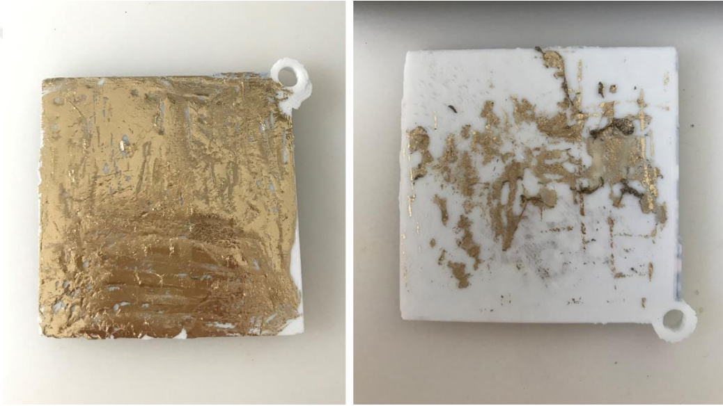
Görsel-49: PLA filamenti üzerine varak baskı. Soldan sağa yıkama öncesi ve yıkama sonrası
