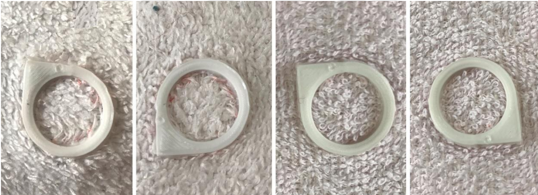
Görsel-35: Soldan sağa baskı sonrası ve yıkama sonrası polyester yüz, baskı sonrası ve yıkama sonrası pamuk yüz.
