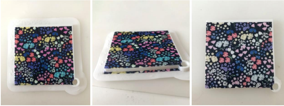
Görsel-47: PLA filamenti üzerine UV baskı sonrası soldan sağa, yatay eksen üst görünüm, düşey eksen, yıkama sonrası.
